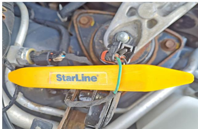
Фото 3.11. Контроль концевика капота (зелёный)
