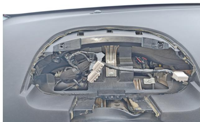
Фото 1.15. Панель приборов снята
