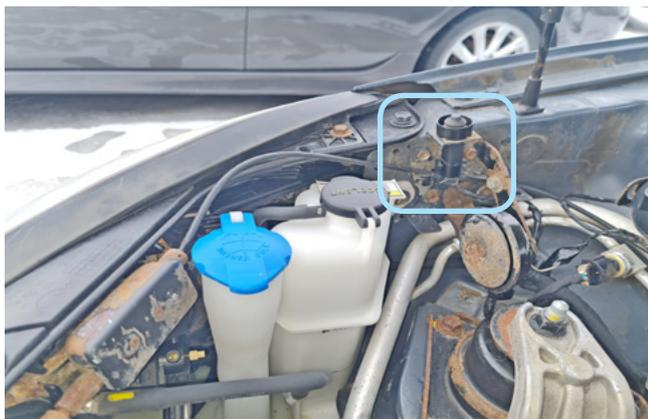
Фото 3.10. Местоположение штатного концевика капота
