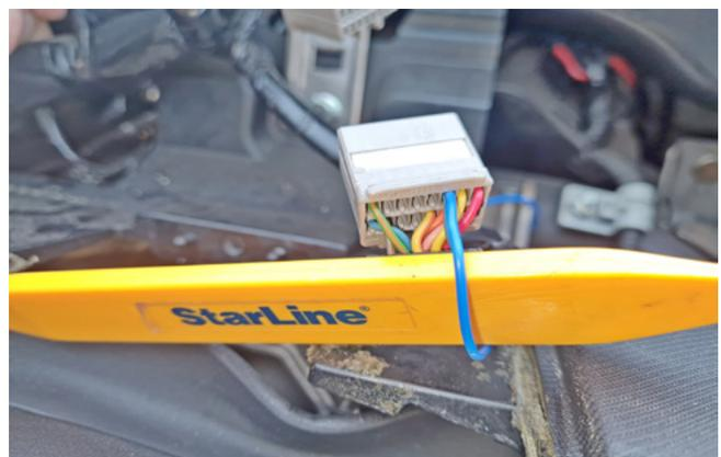
Фото 3.9. Сигнал поворотов (синий)
