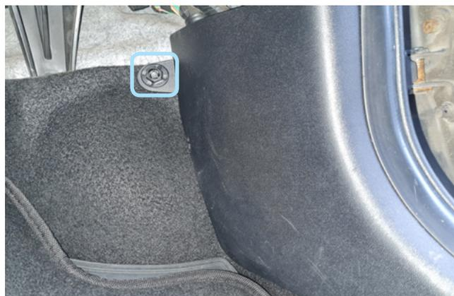
Фото 1.19. Клипса крепления накладки кик-панели
