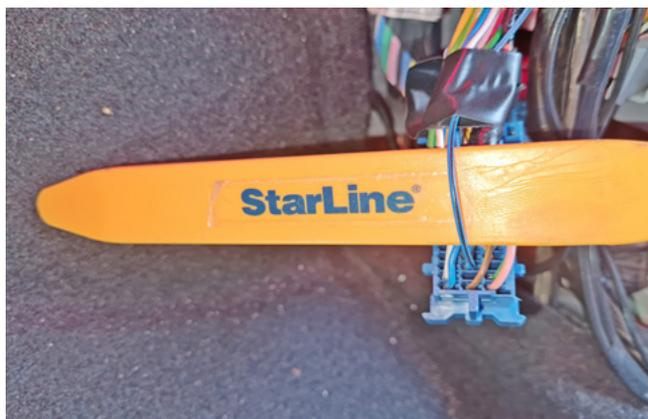
Фото 3.16. Шина данных штатного иммобилайзера (сине-чёрный). Для автомобилей 2010-2011 г.в.
