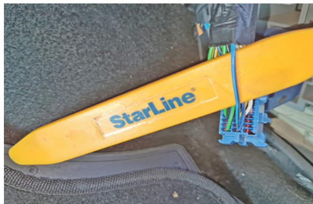
Фото 3.15. Шина данных штатного иммобилайзера (сине-чёрный). Для автомобилей 2006-2010 г.в.
