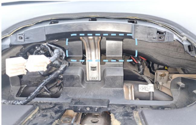
Фото 2.12. Пример расположения центрального блока охранно-телематического комплекса
