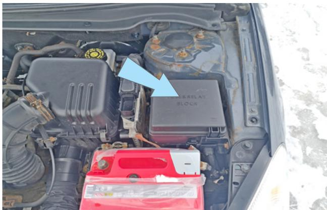
Фото 2.7. Возможное место установки подкапотного блока R6
