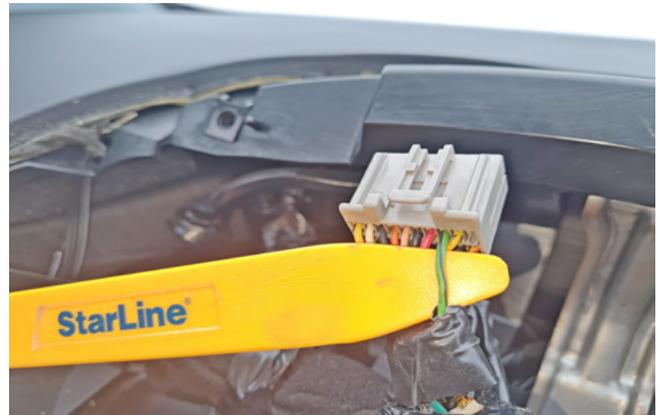
Фото 3.5. Контроль концевика багажника (зелёно-чёрный)
