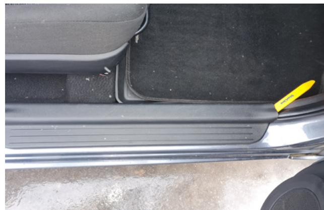
Фото 1.17. Снять накладку порога переднего пассажира
