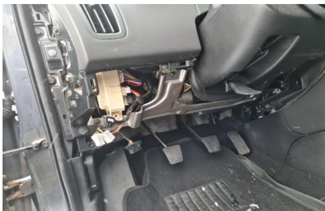
Фото 1.6. Пластиковая накладка снята
