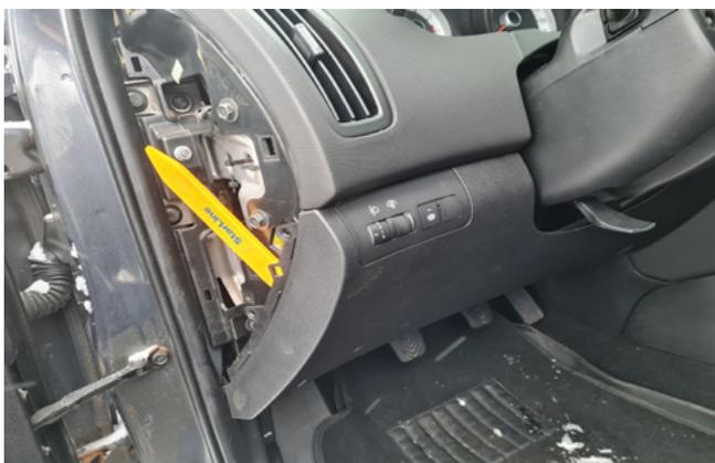
Фото 1.5. Снять пластиковую накладку под рулевой колонкой
