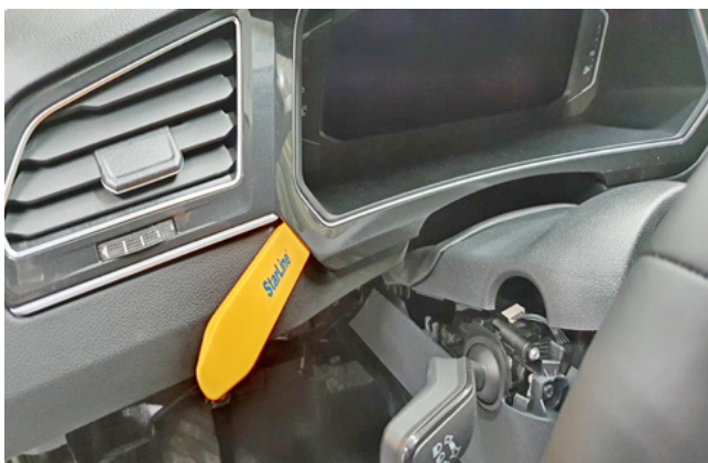
Фото 1.15. Снять декоративную накладку панели приборов
