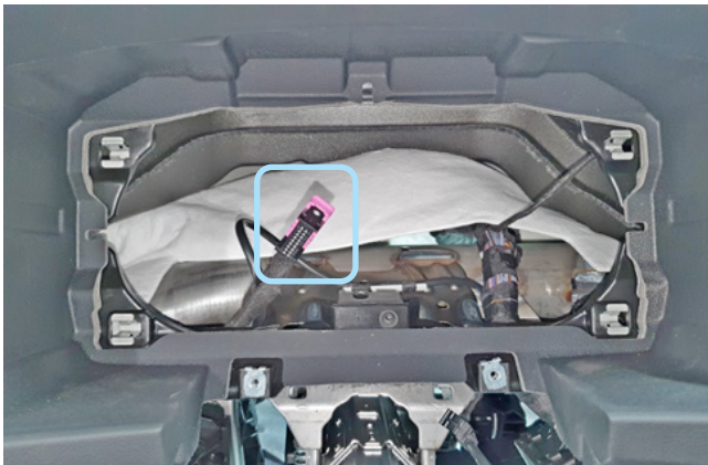
Фото 3.2. Местоположение разъёма панели приборов
