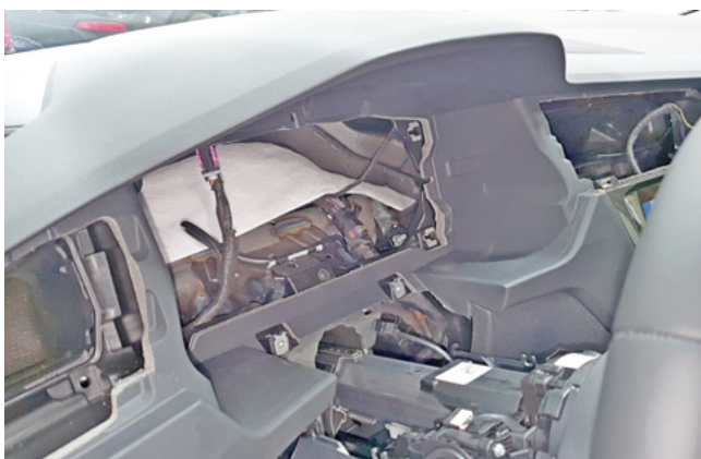
Фото 1.17. Панель приборов снята
