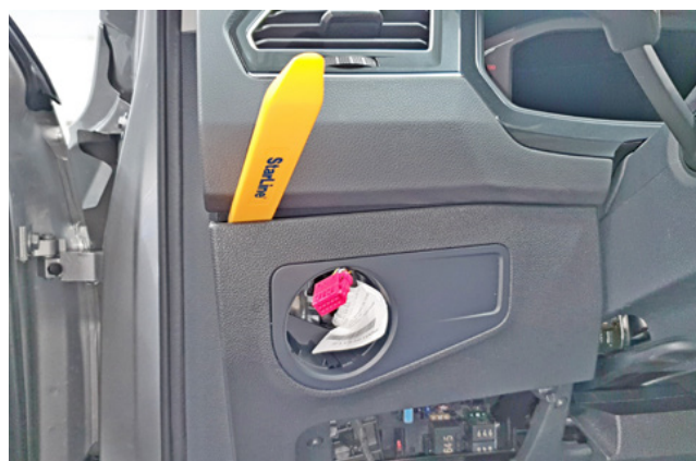
Фото 1.8. Снять накладку слева от рулевой колонки
