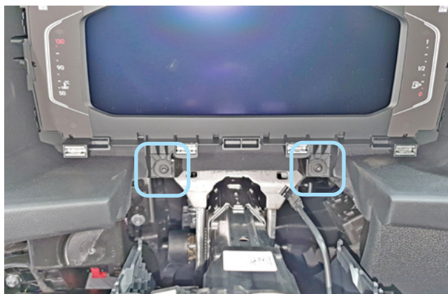
Фото 1.16. Накладка снята. Саморезы крепления панели приборов
