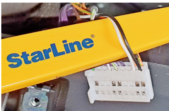
Фото 3.13. Провода антенны штатного иммобилайзера (чёрный и белый)
