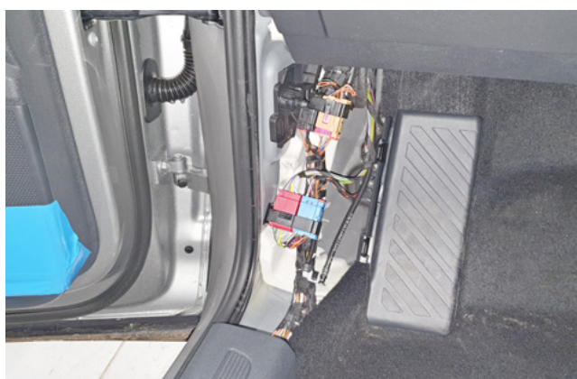
Фото 1.12. Пластиковая накладка левой кик-панели снята
