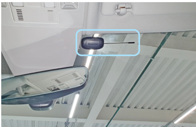
Фото 2.1. Возможное место установки антенного модуля
