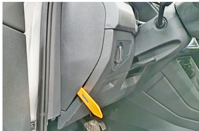
Фото 1.2. Снять боковую накладку передней панели
