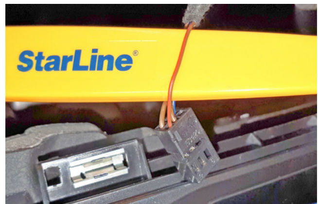
Фото 3.7. Альтернативное управление световыми сигналами (коричнево-красный)
