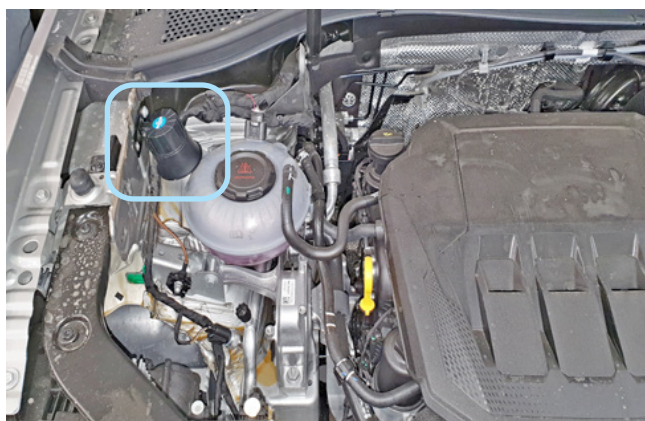
Фото 2.2. Возможное место установки сирены
