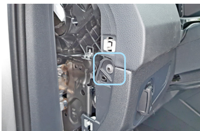
Фото 1.3. Накладка снята. Саморез
