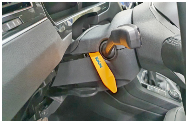
Фото 1.14. Снять верхнюю часть кожуха рулевого вала
