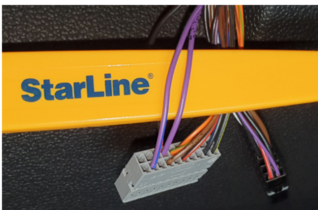
Фото 3.10. Управление кнопкой Старт-Стоп (фиолетовый и фиолетово-синий)
