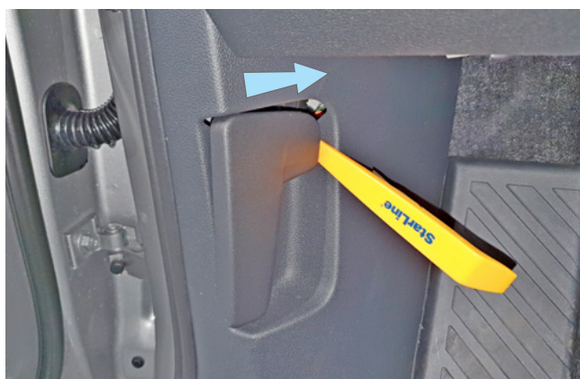
Фото 1.9. Сдвинуть фиксатор ручки отпирания капота в направлении стрелки
