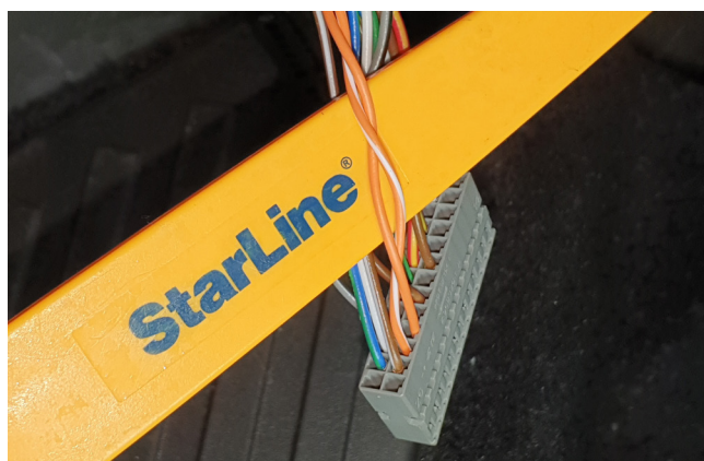
Фото 3.6. Шина CAN-B (pin 24 и pin 23)
