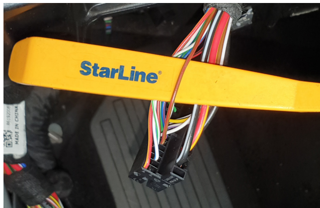
Фото 3.8. Альтернативное управление световыми сигналами (коричнево-красный)
