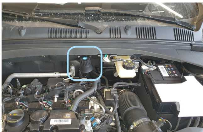
Фото 2.2. Возможное место установки сирены
