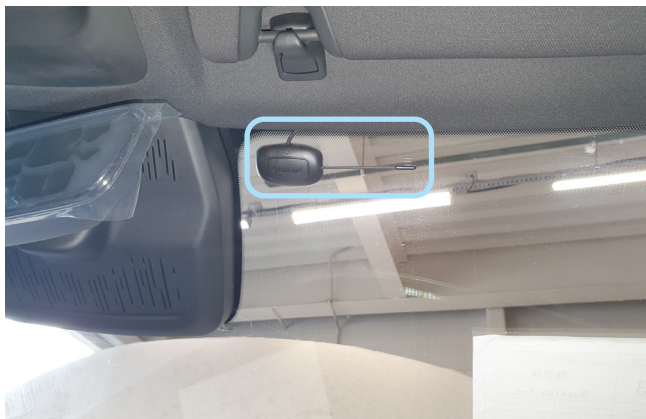
Фото 2.1. Возможное место установки антенного модуля
