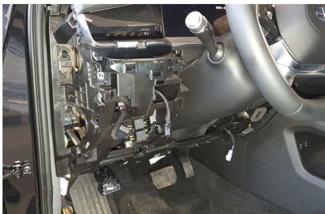
Фото 1.10. Пластиковая накладка под рулевой колонкой снята
