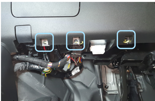
Фото 1.5. Саморезы в нижней части накладки под рулевой колонкой
