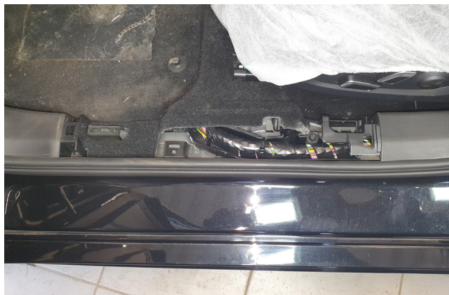
Фото 1.7. Накладка порога двери водителя снята
