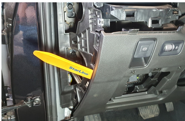
Фото 1.9. Снять пластиковую накладку под рулевой колонкой
