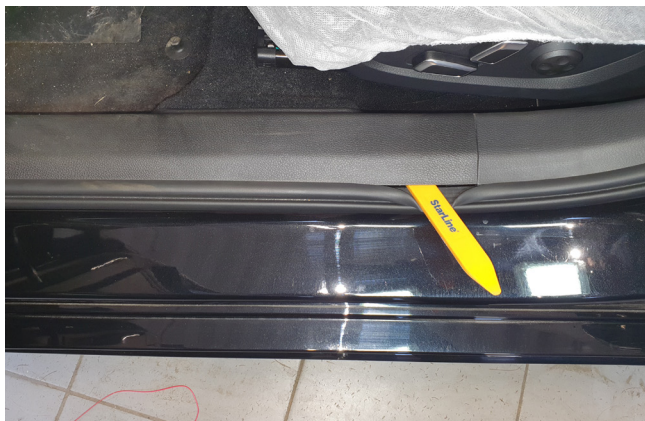
Фото 1.6. Снять накладку порога двери водителя
