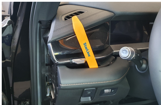
Фото 1.4. Снять декоративную накладку слева от рулевой колонки
