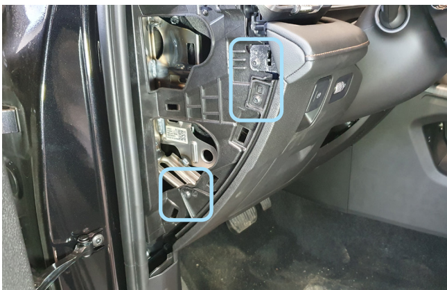
Фото 1.3. Накладка снята. Саморезы
