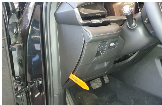
Фото 1.2. Снять левую боковую накладку передней панели
