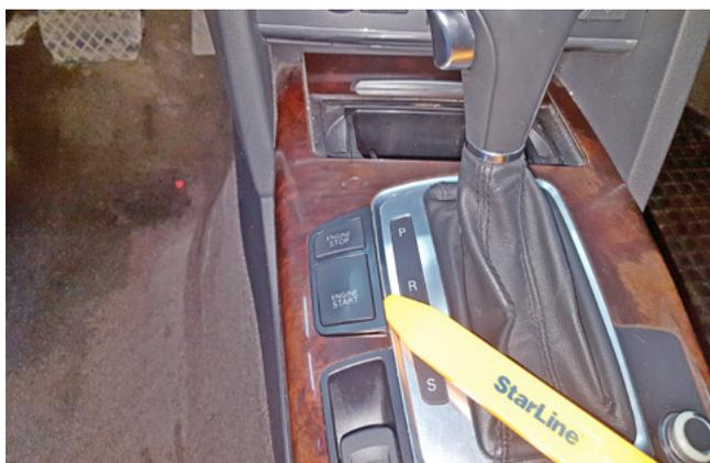
Фото 1.9. Снять кнопку Старт-Стоп
