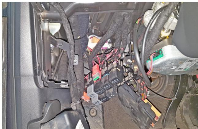
Фото 1.7. Блок ВСМ и монтажный блок предохранителей сняты
