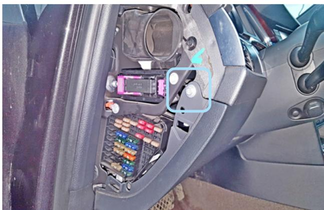
Фото 1.3. Боковая накладка снята. Болт крепления накладки под рулевой колонкой
