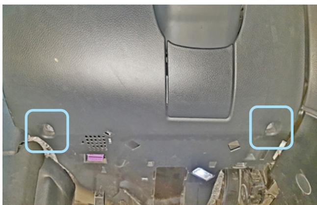
Фото 1.4. Болты крепления накладки снизу
