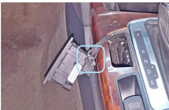
Фото 3.4. Местоположение разъёма кнопки Старт-Стоп
