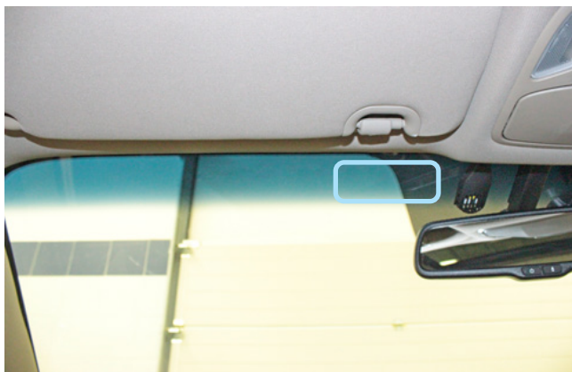
Фото 2.1. Возможное место установки антенны 868 МГц
