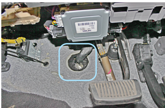
Фото 2.6. Штатный уплотнитель. Вид со стороны салона
