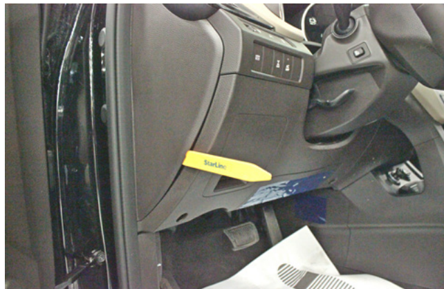
Фото 1.2. Снять боковую накладку передней панели
