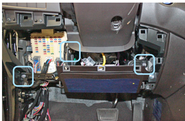
Фото 1.9. Гайки крепления подушки безопасности
