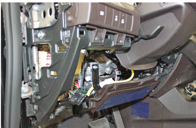
Фото 1.5. Пластиковая накладка под рулевой колонкой снята
