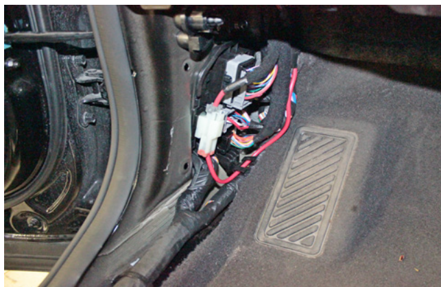
Фото 1.8. Накладка левой кик-панели снята
