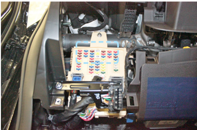
Фото 2.7. Пример расположения центрального блока охранно-телематического комплекса
