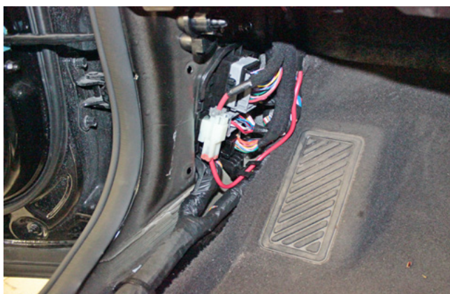
Фото 1.8. Накладка левой кик-панели снята
