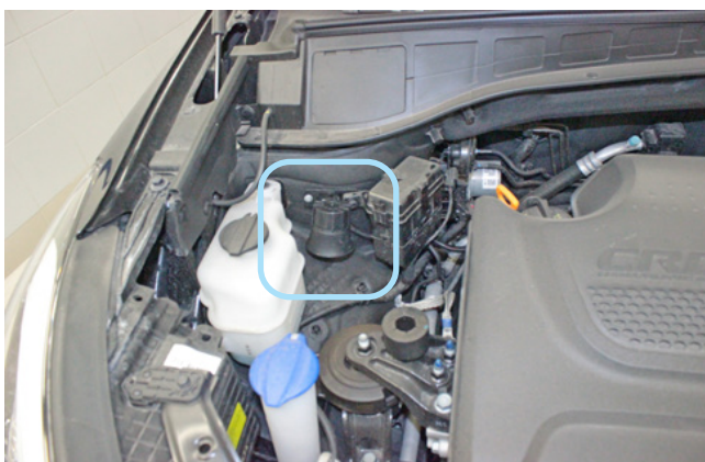
Фото 2.2. Возможное место установки сирены
