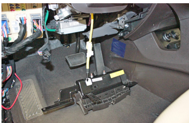
Фото 1.10. Подушка безопасности снята
