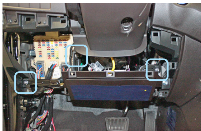
Фото 1.9. Гайки крепления подушки безопасности
