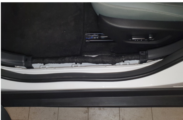
Фото 1.5. Накладка порога двери водителя снята
