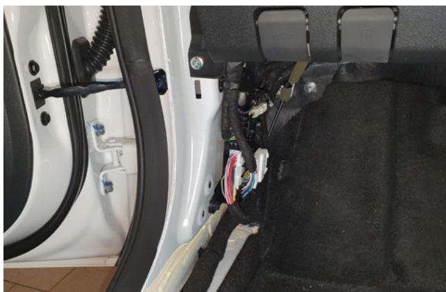
Фото 1.7. Накладка левой кик-панели снята
