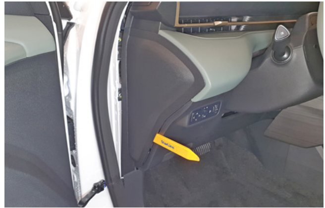
Фото 1.2. Снять боковую накладку передней панели
