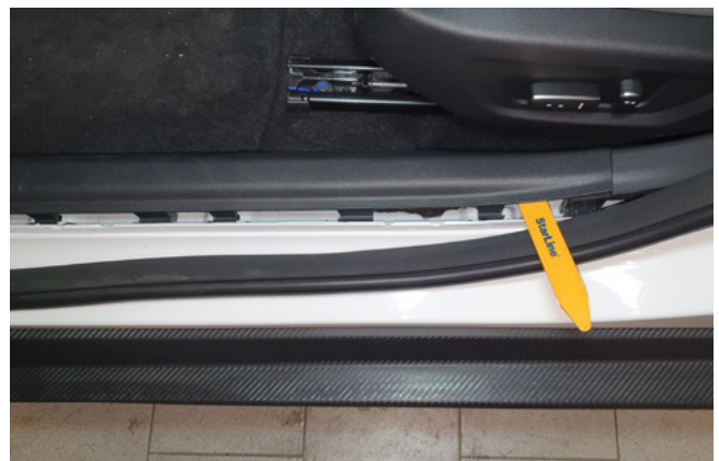
Фото 1.4. Снять накладку порога двери водителя
