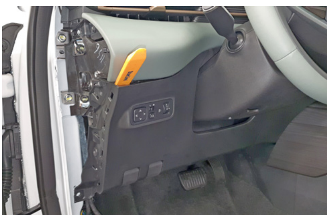
Фото 1.9. Снять пластиковую накладку под рулевой колонкой
