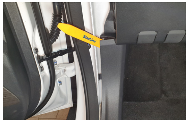
Фото 1.6. Снять накладку левой кик-панели
