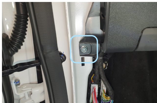
Фото 1.8. Болт крепления пластиковой накладке под рулевой колонкой
