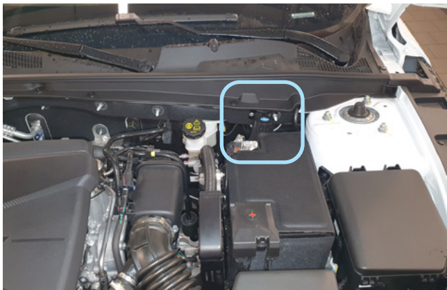
Фото 2.2. Возможное место установки сирены
