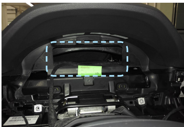
Фото 7. Пример расположения центрального блока охранно-телематического комплекса
