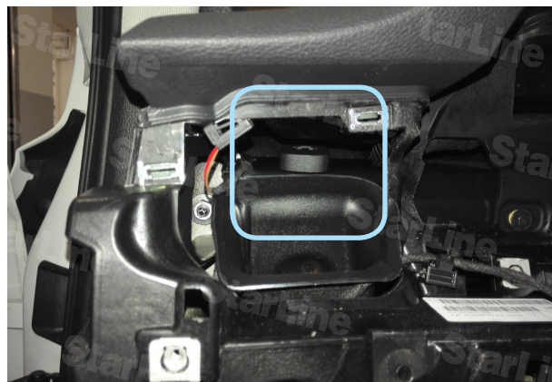
Фото 5.2. Возможное место установки GPS-антенны
