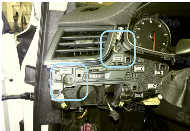
Фото 3.5. Снять дефлектор воздуховода
