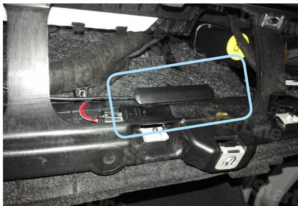
Фото 5.1. Пример расположения GSM антенны
