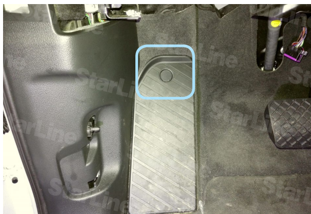
Фото 2.3. Вынуть заглушку крепления опоры ноги водителя
