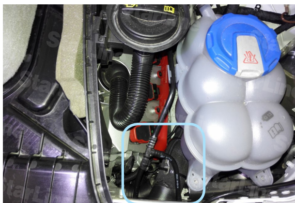
Фото 6.5. Место крепления датчика температуры
