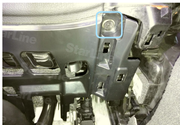
Фото 1.4. Отвернуть болт крепления нижний правый
