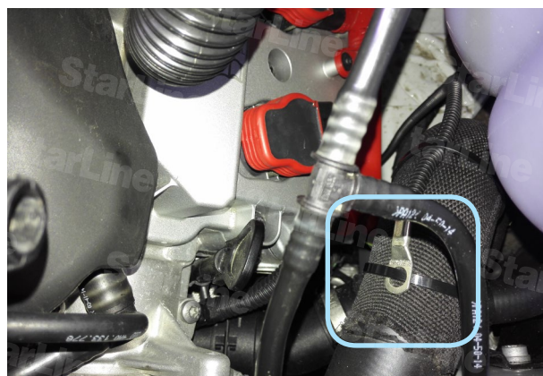
Фото 6.6. Крепление датчика температуры двигателя
