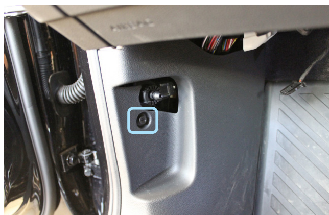
Фото 1.16. Ручка отпирания капота снята. Клипса
