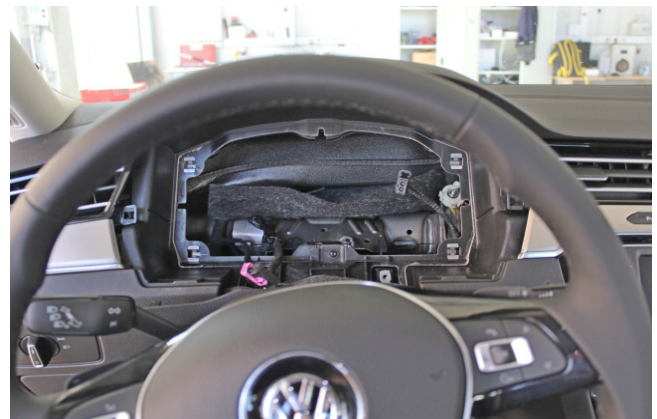
Фото 1.6. Панель приборов снята
