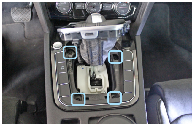
Фото 1.9. Пластиковая накладка рычага переключения передач снята. Саморезы
