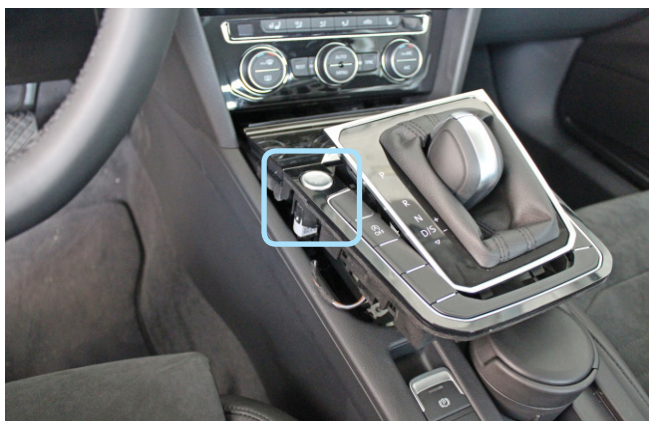
Фото 3.8. Местоположение разъёма кнопки Старт-Стоп
