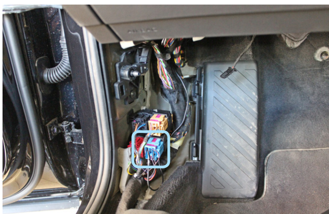
Фото 3.10. Местоположение разъёма в левой кик-панели
