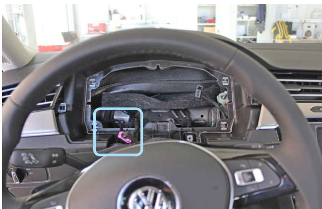
Фото 3.2. Местоположение разъёма панели приборов
