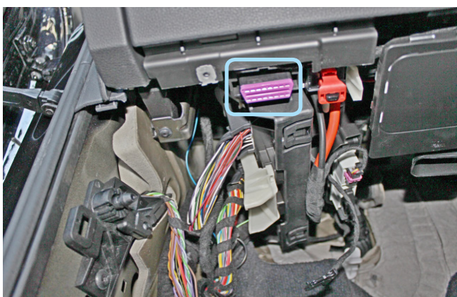
Фото 3.4. Местоположение диагностического разъёма OBD II
