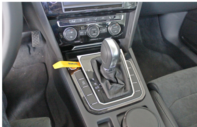
Фото 1.8. Снять пластиковую накладку рычага переключения передач
