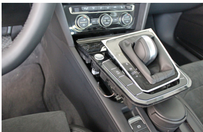
Фото 1.11. Панель кнопок снята
