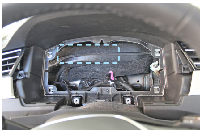
Фото 2.8. Пример расположения центрального блока охранно-телематического комплекса
