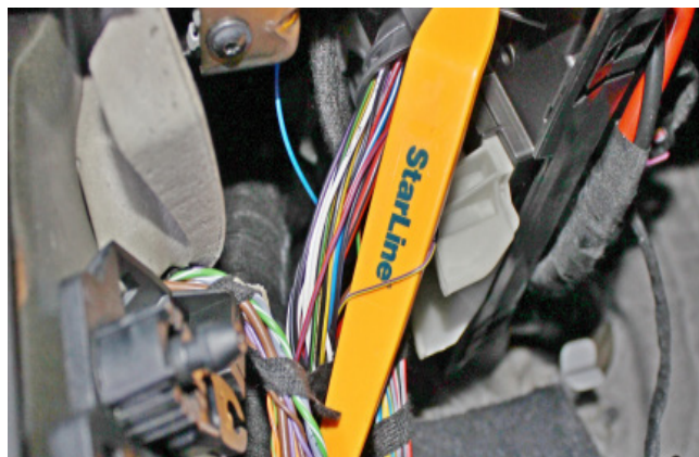
Фото 3.7. Управление световыми сигналами (фиолетово-жёлтый)
