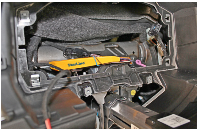
Фото 3.14. Провода штатной антенны в жгуте разъёма панели приборов (синий и коричневый)
