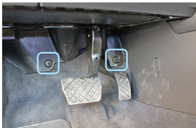
Фото 1.14. Клипсы крепления накладки педального узла
