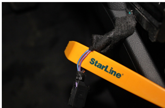
Фото 3.9. Управление кнопкой Старт-Стоп (фиолетовый и фиолетово-синий)
