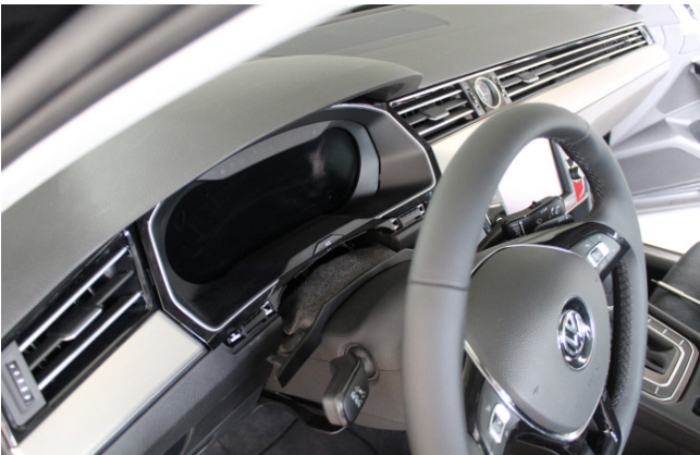
Фото 1.3. Пластиковая накладка под панелью приборов снята
