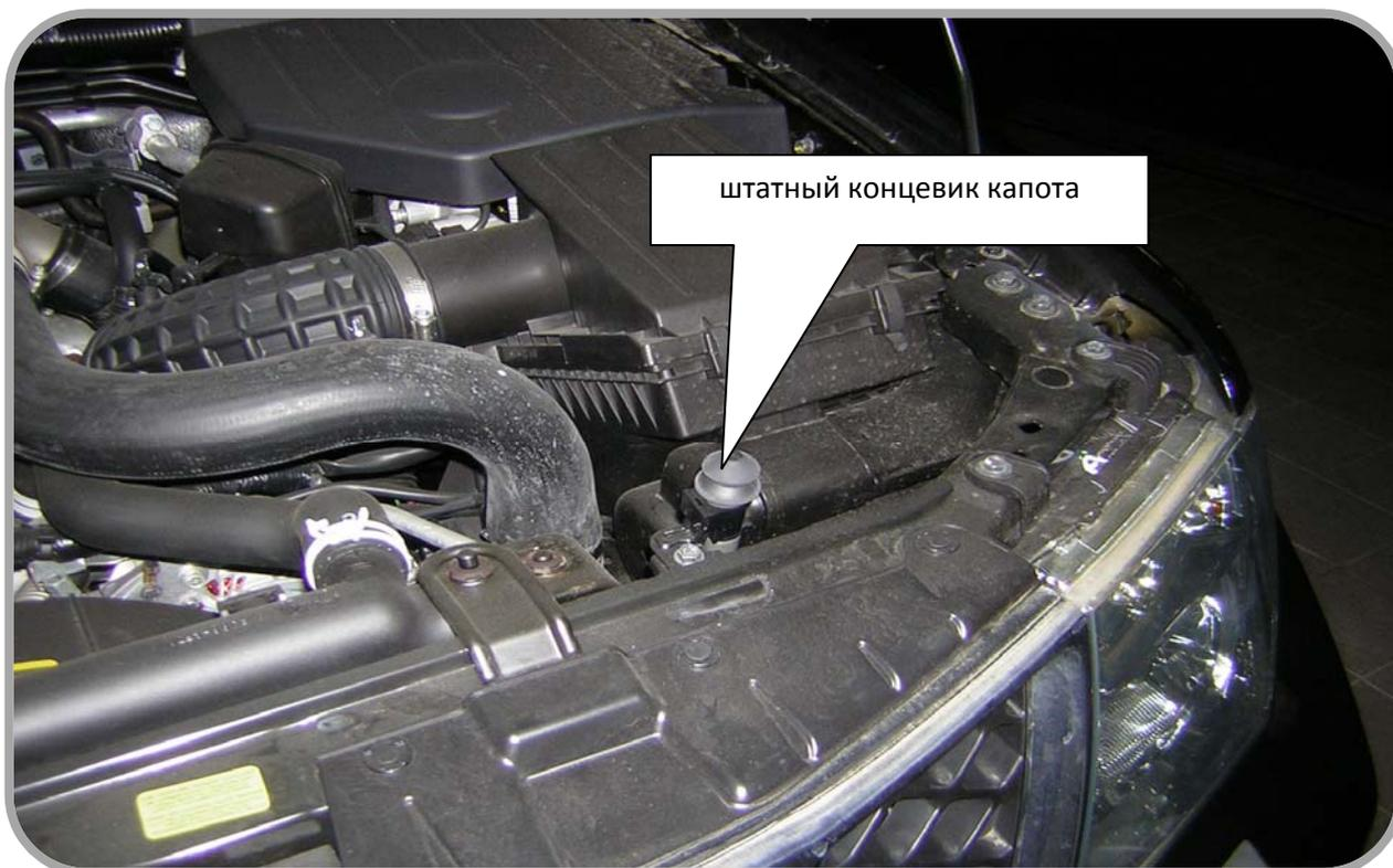
штатный концевик капота
