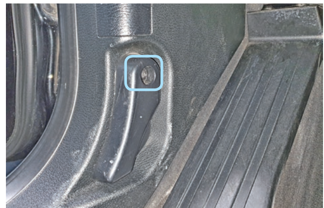
Фото 1.11. Саморез крепления ручки отпирания капота
