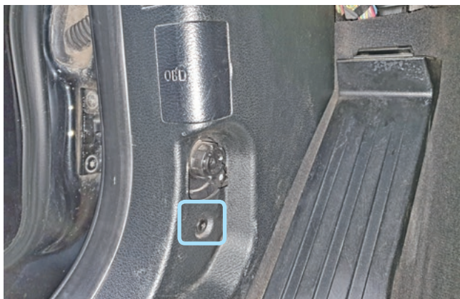
Фото 1.12. Саморез крепления накладки левой кик-панели
