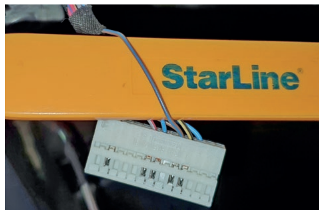
Фото 3.6. Альтернативное управление световыми сигналами (коричнево-синий)
