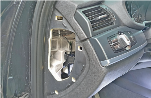
Фото 1.6. Левая накладка передней панели снята
