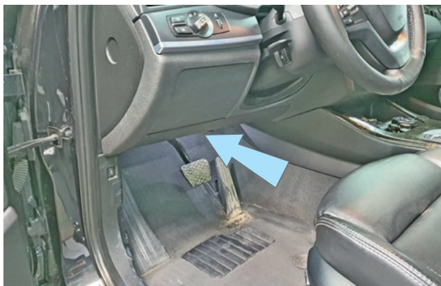
Фото 1.1. Накладка pedalного узла. Общий вид
