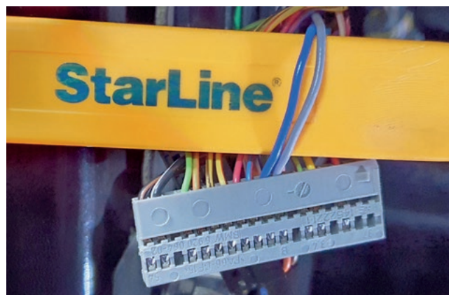
Фото 3.4. Шина CAN-B (серый и синий)
