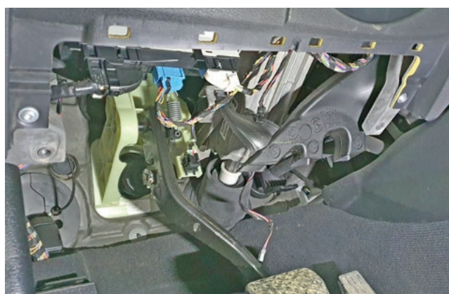
Фото 1.4. Накладка pedalного узла снята
