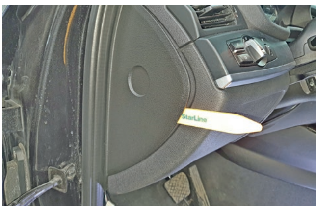
Фото 1.5. Снять левую накладку передней панели
