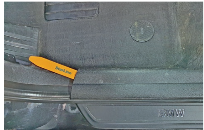
Фото 1.9. Снять накладку порога двери водителя
