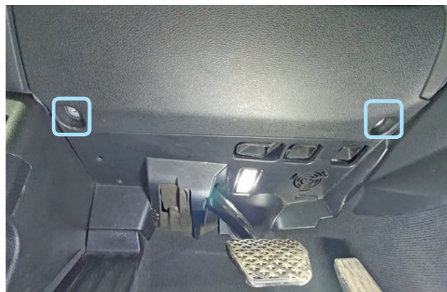
Фото 1.2. Саморезы крепления pedalного узла
