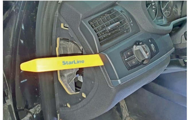
Фото 1.7. Снять блок кнопок переключателя света
