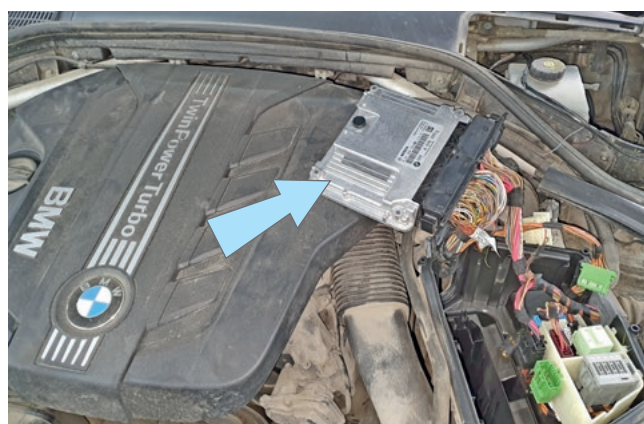
Фото 2.3. Блок управления двигателем снят
