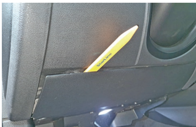
Фото 1.3. Снять накладку pedalного узла
