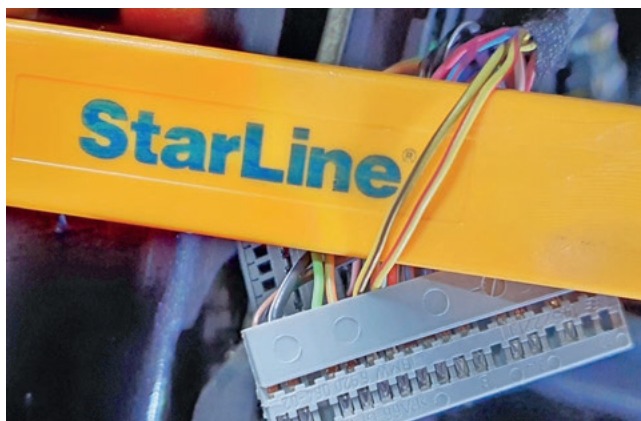
Фото 3.3. Шина CAN-A (жёлто-красный и жёлто-коричневый)
