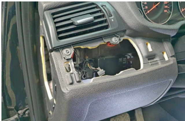
Фото 1.8. Блок кнопок снят
