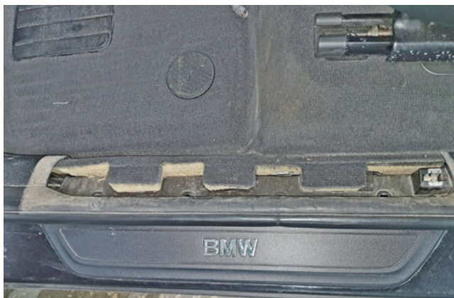
Фото 1.10. Накладка порога двери водителя снята
