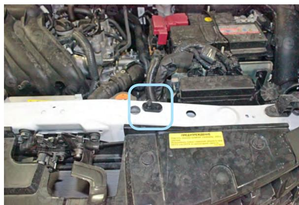
Фото 5.4. Концевик капота
