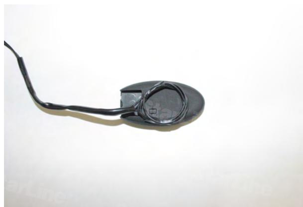
Фото 10.2. Расположение антенны модуля VP-03 на ключе
