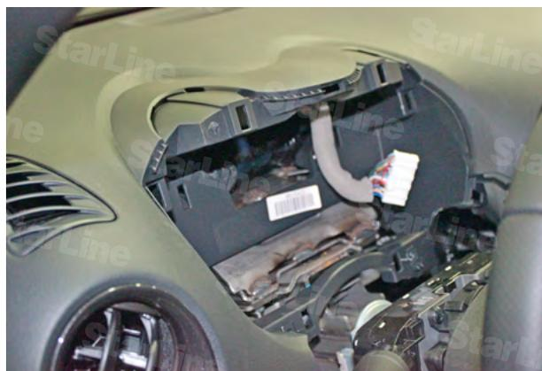
Фото 3.3. Щиток приборов снят
