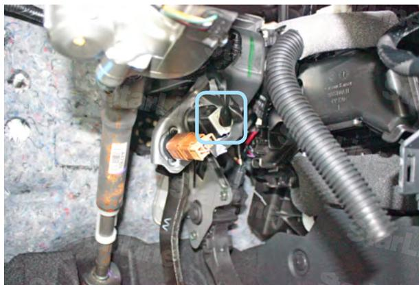
Фото 9.3. Местоположение разъёма педали тормоза
