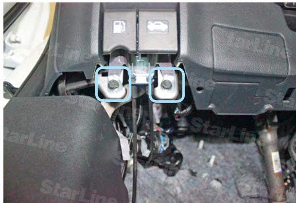
Фото 1.2. Болты крепления ручки открытия капота
