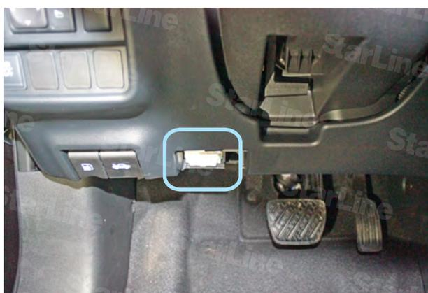
Фото 8.1. Расположение диагностического разъёма
