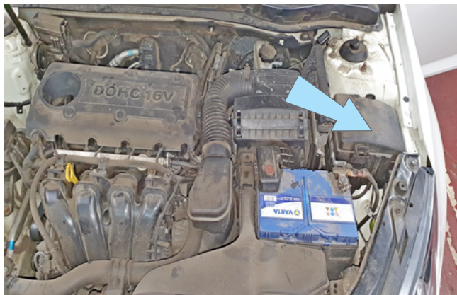
Фото 2.6. Возможное место установки подкапотного блока R6
