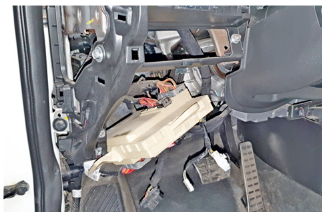
Фото 1.12. Монтажный блок предохранителей снят
