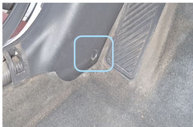
Фото 1.4. Клипса крепления накладки левой кик-панели
