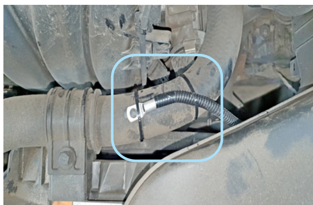
Фото 2.4. Крепление датчика температуры двигателя
