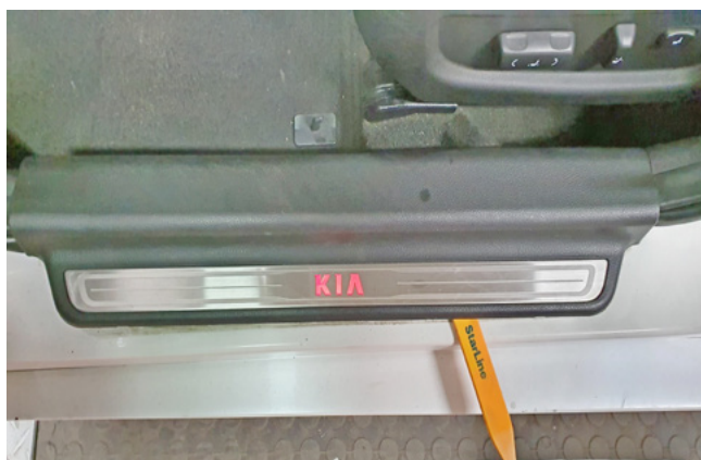
Фото 1.3. Снять накладку порога двери водителя
