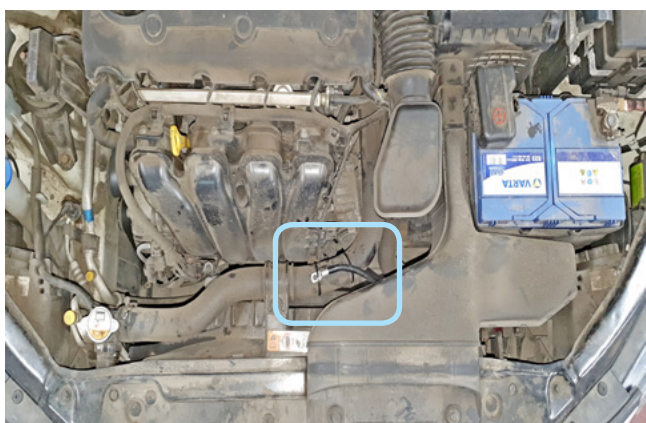
Фото 2.3. Место установки датчика температуры двигателя
