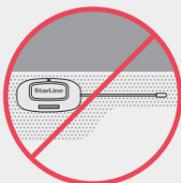
**Внимание!** Не размещайте приемопередатчик на шелкографии лобового стекла, это приводит к снижению дальности действия охранного оборудования. Наличие обогрева лобового стекла также может снижать дальность работы.
