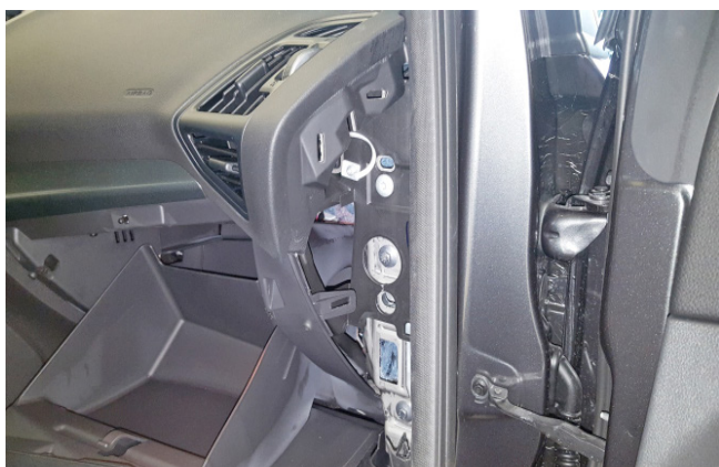
Фото 1.3. Боковая накладка передней панели снята
