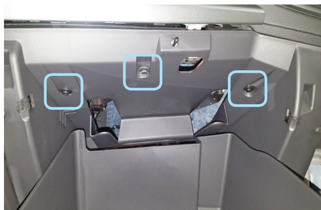
Фото 1.4. Саморезы крепления перчаточного ящика
