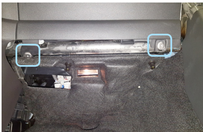
Фото 1.5. Винты крепления перчаточного ящика
