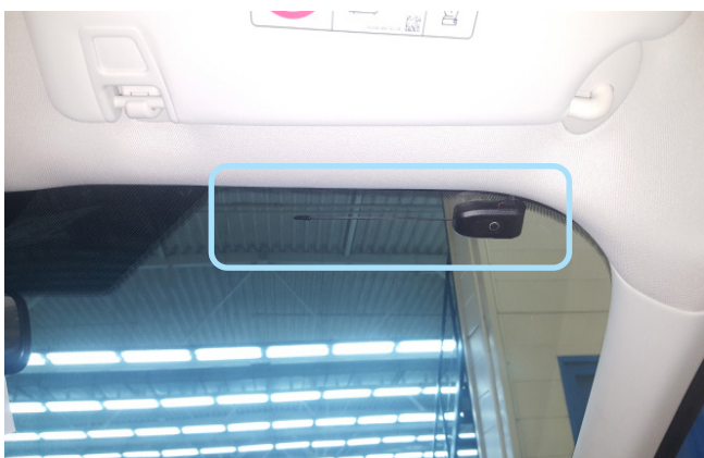
Фото 2.1. Возможное место установки антенного модуля
