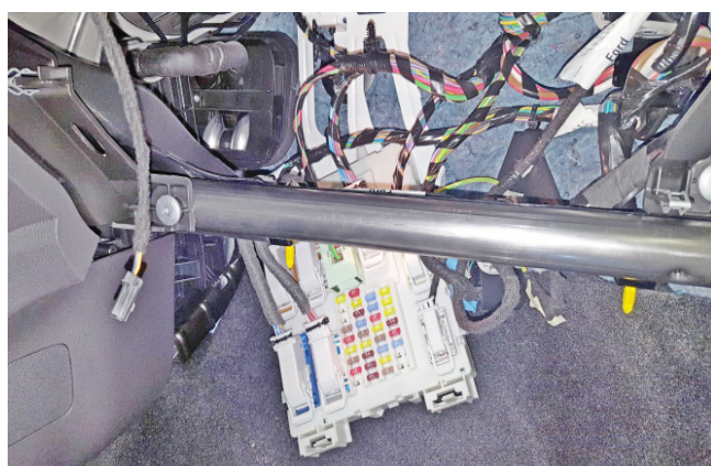
Фото 1.9. Блок BCM снят
