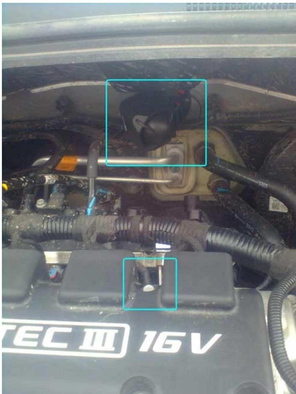
Фото 2.8. Под капотом устанавливаем сирену, на двигателе – датчик температуры, протянув провода через штатное уплотнение за блоком ВСМ.
