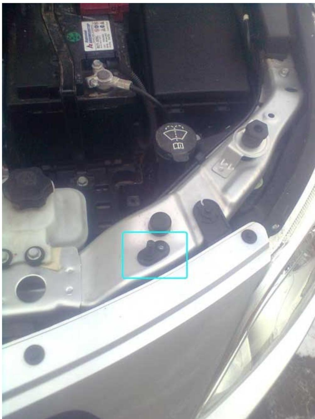
Фото 2.10. Устанавливаем концевик капота на планке радиатора, рассверлив имеющееся отверстие рядом с грибком-опорой капота.
