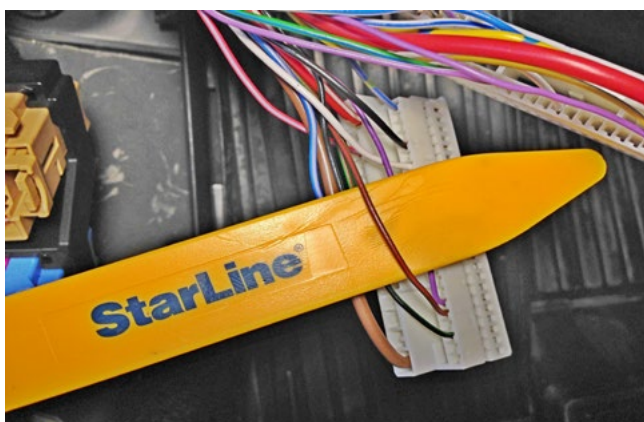
Фото 3.7. Альтернативное управление световыми сигналами (коричнево-красный)
