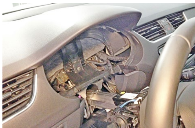
Фото 1.15. Панель приборов снята
