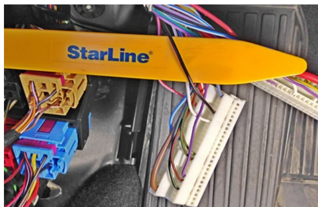
Фото 3.13. Разъём С, имитация нажатия педали тормоза (чёрно-красный)
