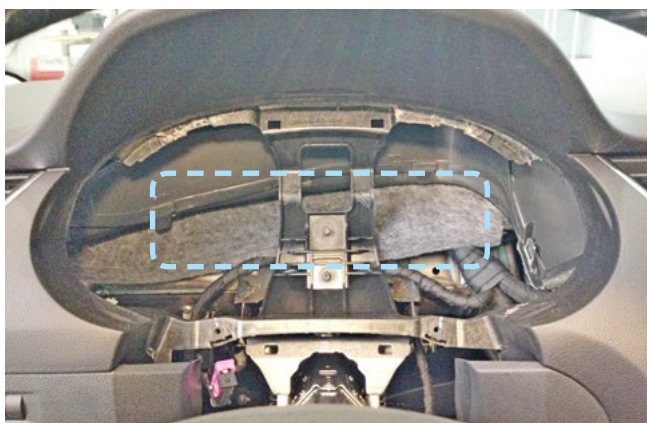
Фото 2.9. Пример расположения центрального блока охранно-телематического комплекса
