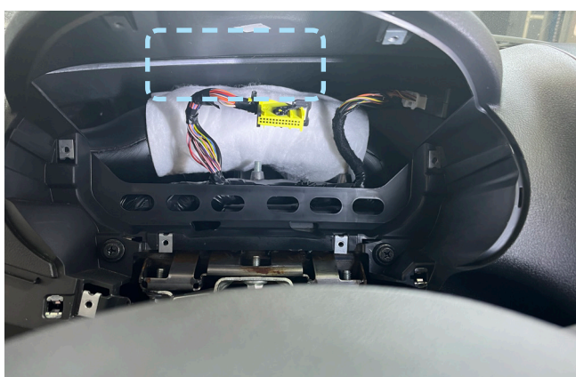
Фото 2.7. Пример расположения центрального блока охранно-телематического комплекса
