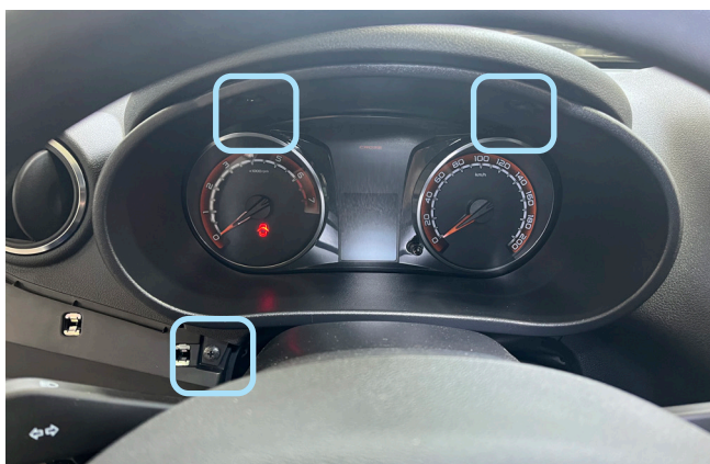
Фото 1.9. Саморезы крепления декоративной накладки
