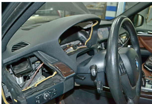
Фото 2.7. Панель приборов снята
