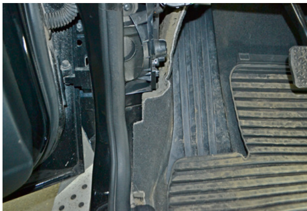
Фото 1.7. Пластиковая накладка левой кик-панели снята
