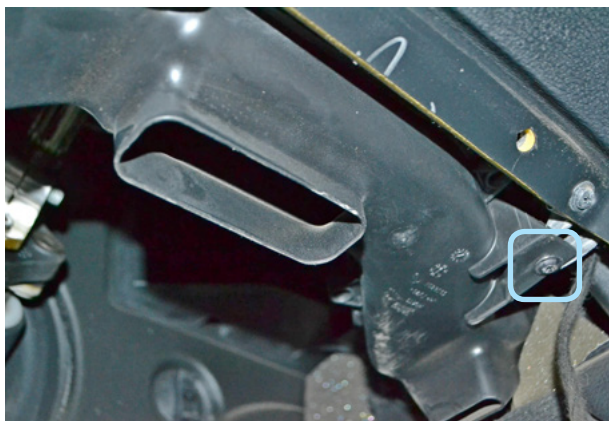
Фото 1.3. Саморез крепления нижнего воздуховода
