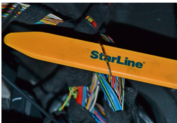
Фото 12. Провод концевика двери водителя (коричнево-жёлтый)
