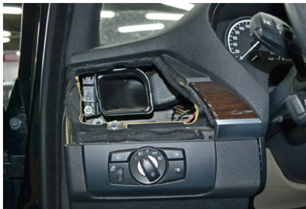
Фото 2.5. Левый воздуховод снят
