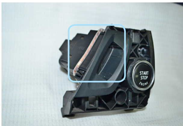
Фото 11.3. Расположение антенны модуля BP-03 на слоте ключа
