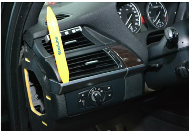
Фото 2.3. Снять накладку под левым воздуховодом
