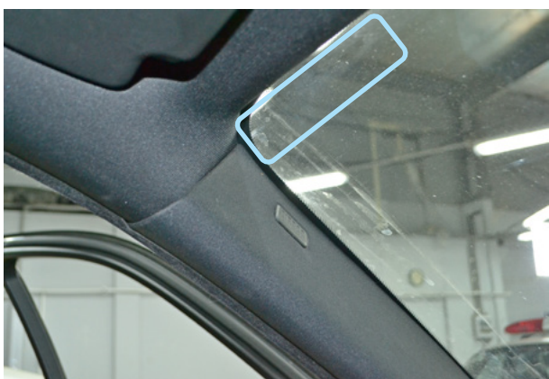
Фото 4.1. Возможное место установки антенного модуля
