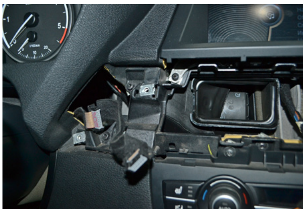
Фото 3.5. Слот ключа снят
