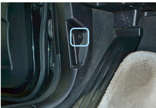
Фото 1.5. Саморез крепления ручки отпирания капота.
