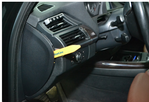
Фото 2.2. Снять боковую накладку передней панели
