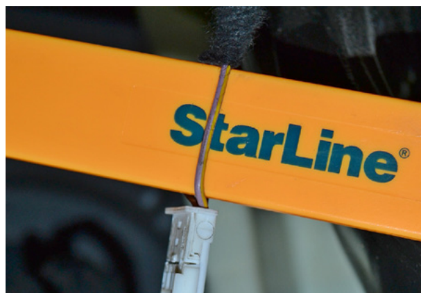
Фото 10.4. Концевик педали тормоза (фиолетово-жёлтый)
