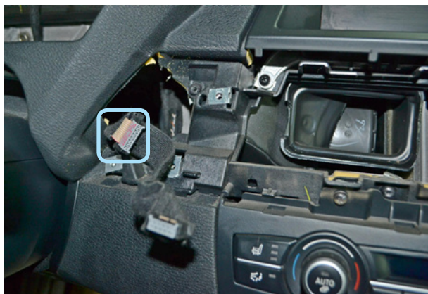
Фото 9.1. Местоположение разъёма шлейфа замка зажигания
