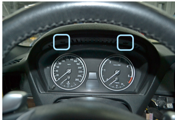
Фото 2.6. Саморезы крепления панели приборов
