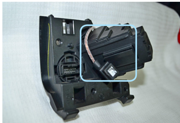
Фото 11.2. Расположение антенны модуля BP-03 на слоте ключа
