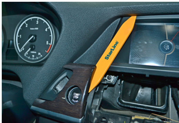
Фото 3.3. Снять накладку кнопки Старт-Стоп
