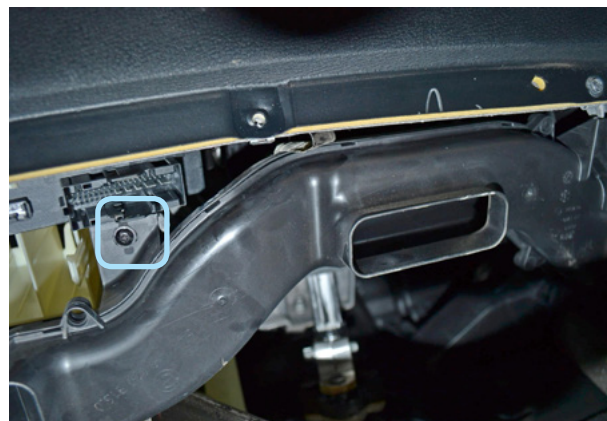
Фото 1.4. Саморез крепления нижнего воздуховода
