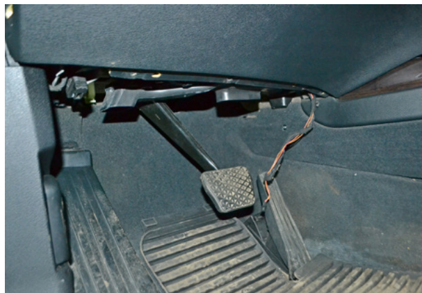
Фото 1.2. Накладка педального узла снята
