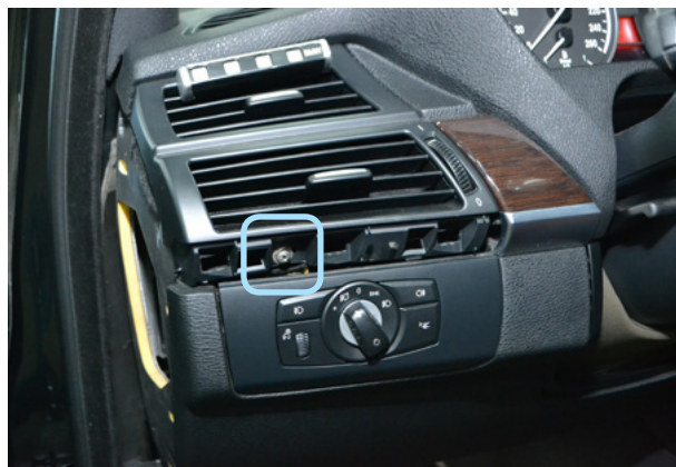
Фото 2.4. Саморез крепления левого воздуховода
