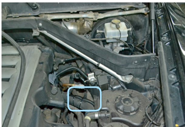
Фото 5.3. Место установки датчика температуры двигателя
