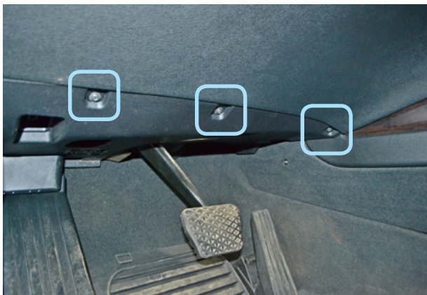
Фото 1.1. Саморезы крепления накладки педального узла
