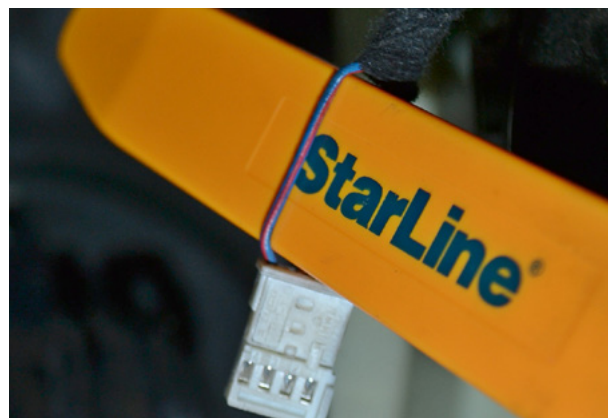
Фото 10.2. Концевик педали тормоза (сине-красный)
