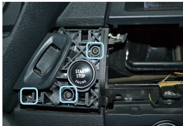
Фото 3.4. Саморезы крепления слота ключа
