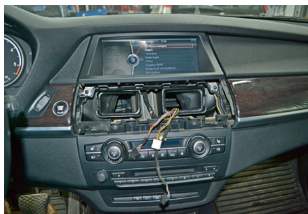
Фото 3.2. Панель центральных воздуховодов снята
