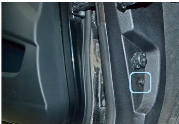
Фото 1.6. Саморез крепления накладке левой кик-панели
