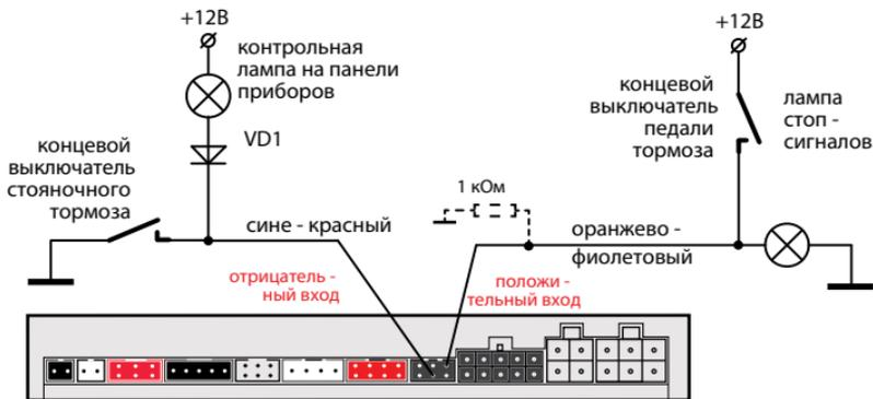
При подключении к стояночному тормозу необходимо подключить диод (VD1 - 1N4007) в разрыв штатного провода стояночного тормоза и подсоединить вход комплекса между катодом диода и концевым выключателем.
