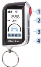
4-кнопочный брелок с обратной связью и жидкокристаллическим (ЖК) дисплеем.
