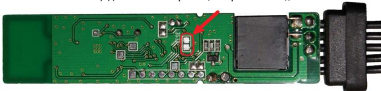
2. на 10 секунд подайте питание на реле. После отключения питания разомкните контактные площадки. Теперь реле снова можно записать в память комплекса.
