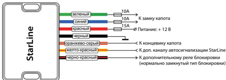
**Зеленый провод, синий провод** – силовые релейные выходы управления электроприводом замка капота. В нормальном состоянии на этих выходах присутствует «масса» (схему контактов встроенных реле см. ниже). Для запирании замка капота – на зеленом проводе появляется +12 В на 0,8 сек. Для отпирании замка капота – на синем проводе появляется +12 В на 0,8 сек.
