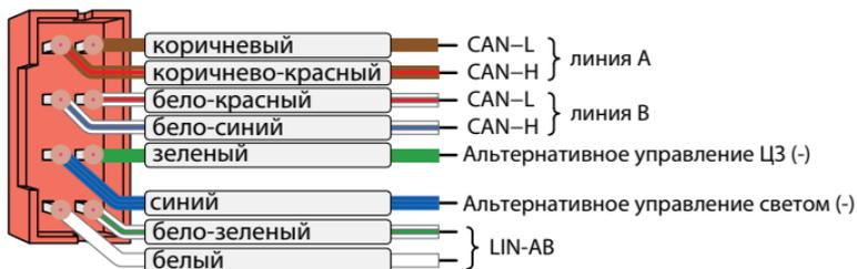
Подключение к разъему X9 с установленным в центральный блок модулем 3CAN+4LIN.
