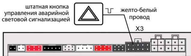
Для доп. канала №3 нужно выбрать фиксированную функцию №18.
