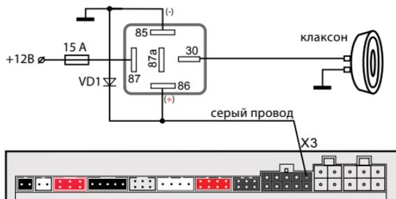
На некоторых автомобилях возможно управление клаксонами по CAN-шине. Управление клаксонами осуществляется только в тревоге. Для выбора управления клаксонами по CAN-шине выберите вариант 2, 3 или 4 функции 6 в табл. №1 (см. стр. 90).
