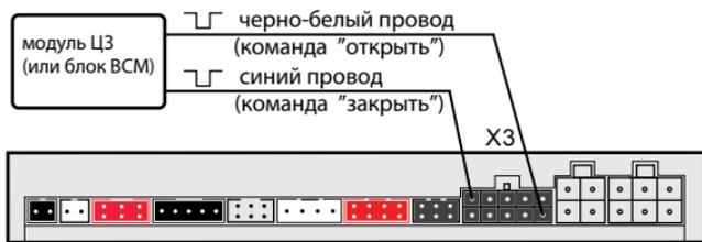
\* Для охранных комплексов StarLine с установленным 3CAN+4LIN, 2CAN+2LIN, 2CAN или CAN+LIN модулем.
