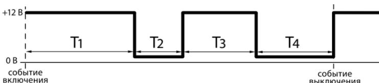
Где: T1 - задержка первого импульса относительно события включения;
