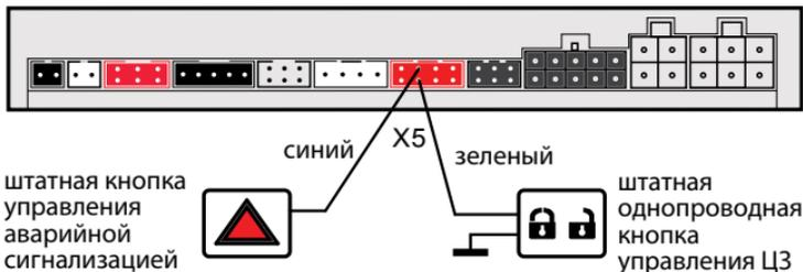
Выходы альтернативного управления активируются автоматически (после установки в блок 2CAN+2LIN, 2CAN или CAN+LIN модуля и записи в память комплекса номера, соответствующего Вашему автомобилю). Активный управляющий уровень - отрицательный. Информацию о возможности альтернативного управления и способах подключения Вы можете найти на странице [can.starline.ru](http://can.starline.ru)
