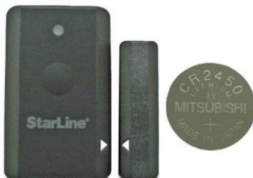
Для установки элемента питания, вскройте корпус герконового датчика, поддав его тупым тонким предметом. Далее установите элемент питания, соблюдая полярность.
