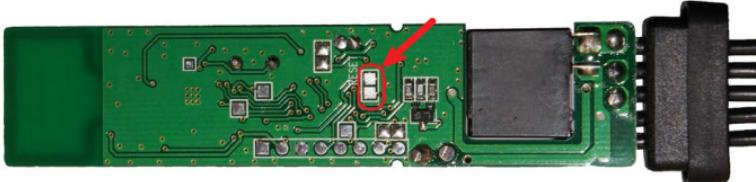
2. на 10 секунд подайте питание на реле. После отключения питания разомкните контактные площадки. Теперь реле снова можно записать в память комплекса.
