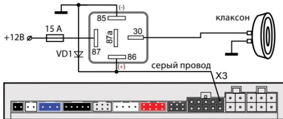
На некоторых автомобилях возможно управление клаксоном по CAN-шине. Управление клаксоном осуществляется только в тревоге. Для выбора управления клаксоном по CAN-шине выберите вариант 2, 3 или 4 функции 6 в табл. №1 (см. стр. 81).
