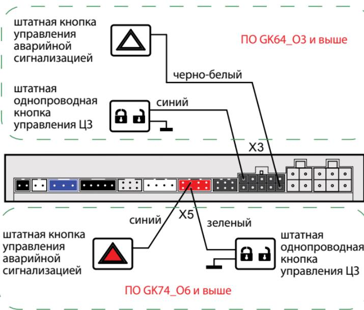
Выходы альтернативного управления активируются автоматически (после установки в блок 2CAN+2LIN, 2CAN или CAN+LIN модуля и записи в память комплекса номера, соответствующего Вашему автомобилю). Активный управляющий уровень - отрицательный. Информацию о возможности альтернативного управления и способах подключения Вы можете найти на странице [can.starline.ru](http://can.starline.ru)
