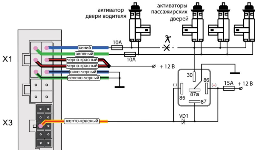
Для реализации двухшагового отпирания замков дверей функция 14 таб. №1 должна быть запрограммирована на вариант 1.
