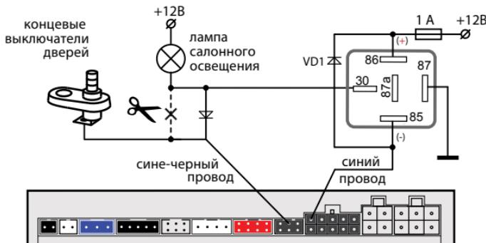
Дополнительный канал 4 также может быть использован для подключения к ближнему свету фар и реализации функции «световая дорожка». Схема подключения приведена далее.
