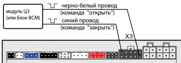
Для классического слаботочного управления ЦЗ необходимо будет использовать доп. каналы №4 (закрыть) и №5 (открыть), контакты 10 и 1 разъема X3. При этом функции 12 и 19 таб. №1 следует запрограммировать на вариант 3. Длительность импульсов управления программируется функцией 1 таб №1.
