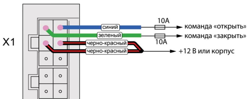
**Подключение к двухпроводным приводам системы запирания**
