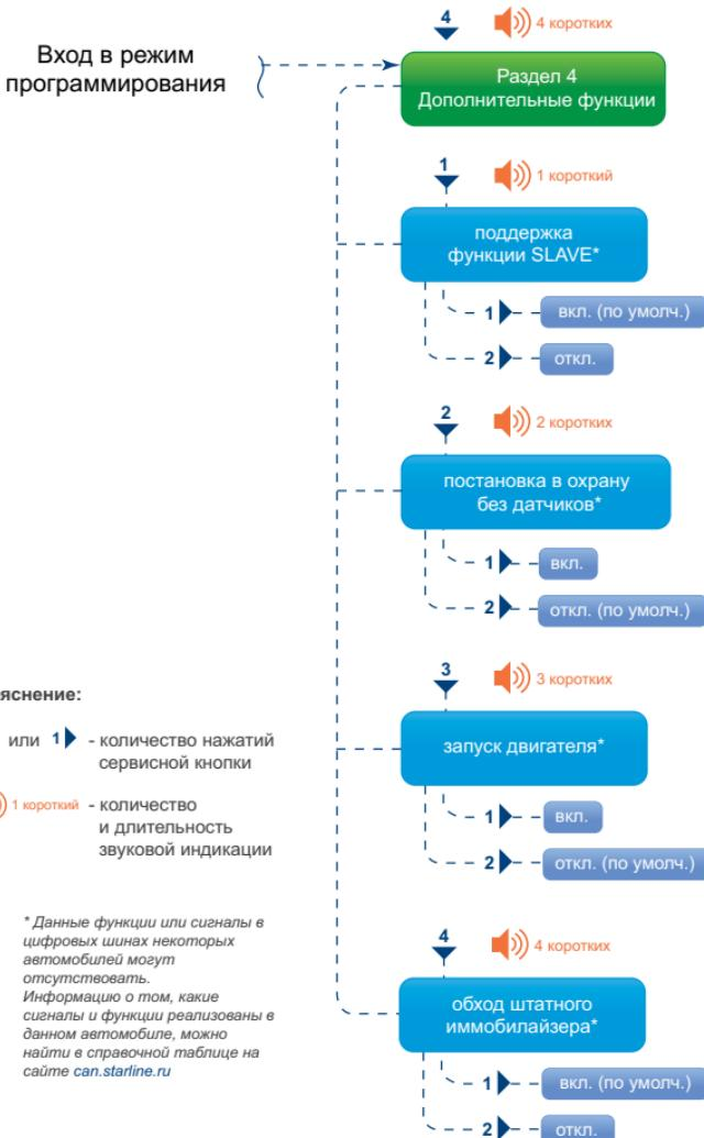
\* Данные функции или сигналы в цифровых шинах некоторых автомобилей могут отсутствовать.
