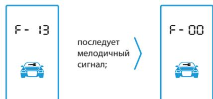
После выбора становится возможным гибкое программирование. При нажатии кнопки 3 сначала длительно (до звукового сигнала), а затем коротко мы переходим к программированию временных интервалов.
