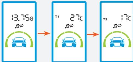
*\*Измеряемые значения напряжения АКБ, температуры салона и температуры двигателя носят только информационный характер, по которым можно косвенно судить о измеренных параметрах (StarLine A93 v2, A63 v2, A39 v2, A36 v2 не является измерительным прибором). Контроль температуры двигателя возможен только при подключенном к комплексу датчике температуры двигателя. Датчик температуры двигателя в комплекте только StarLine A93 v2, A39 v2.*
