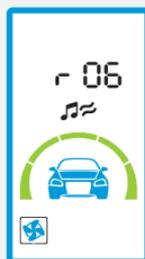
**3** | Нажмите кнопку 1 длительно (до звукового сигнала). Или дождитесь автоматического (через 4 сек.) сохранения выбранного времени работы турботаймера.
