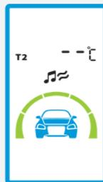
Если температура ниже  $-40^{\circ}\text{C}$  или датчик не подключен, то индикация температуры **T2** не отображается.
