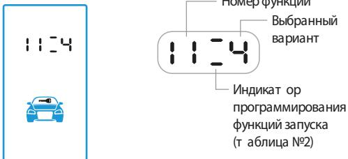
5. Для выхода из режима программирования выключите зажигание или дождитесь автоматического выхода системы.
