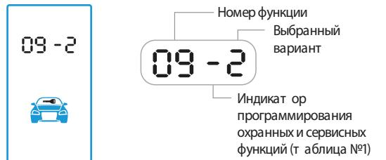
5. Для выхода из режима программирования выключите зажигание или дождитесь автоматического выхода системы.
