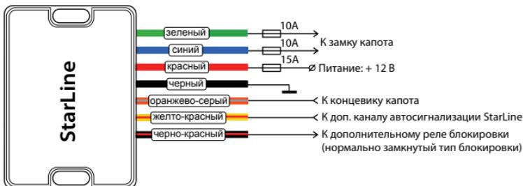
**Зеленый провод, синий провод** – силовые релейные выходы управления электроприводом замка капота. В нормальном состоянии на этих выходах присутствует «масса» (схему контактов встроенных реле см. ниже). Для запирания замка капота – на зеленом проводе появляется +12 В на 0,8 сек. Для отпирания замка капота – на синем проводе появляется +12 В на 0,8 сек.
