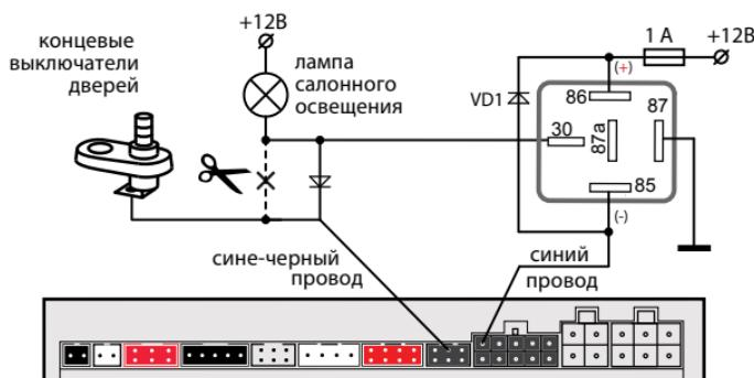
**Схема реализации функции «световая» дорожка с помощью доп. канала №4:**
