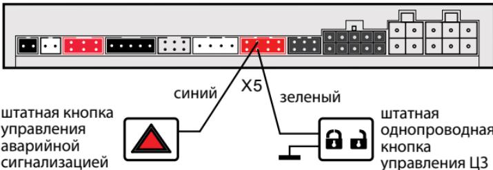
Выходы альтернативного управления активируются автоматически (после установки в блок 2CAN+2LIN, 2CAN или CAN+LIN модуля и записи в память комплекса номера, соответствующего Вашему автомобилю). Активный управляющий уровень - отрицательный. Информацию о возможности альтернативного управления и способах подключения Вы можете найти на странице [can.starline.ru](http://can.starline.ru)
