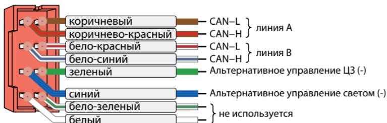
Подключение к разъему X5 с установленным в центральный блок модулем CAN+LIN.
