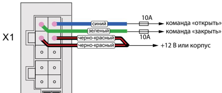
**Подключение к двухпроводным приводам системы запирания
