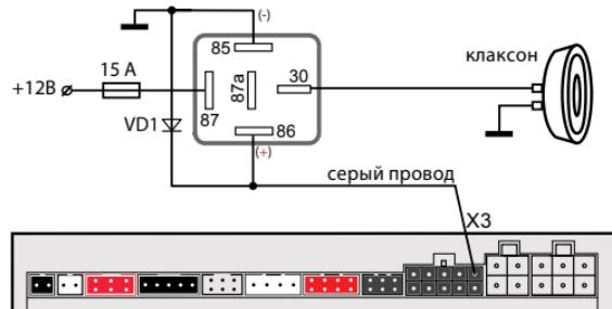
На некоторых автомобилях возможно управление клаксоном по CAN-шине. Управление клаксоном осуществляется только в тревоге. Для выбора управления клаксоном по CAN-шине выберите вариант 2, 3 или 4 функции 6 в табл. №1.
