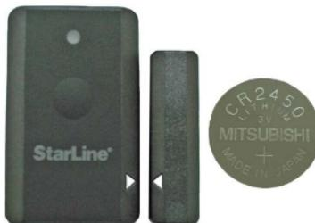
Для установки элемента питания, вскройте корпус герконового датчика, поддев его тупым тонким предметом. Далее установите элемент питания, соблюдая полярность.
