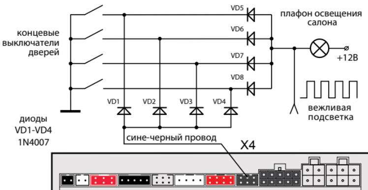
**Схема диодной развязки для концевых выключателей положительной полярности**
