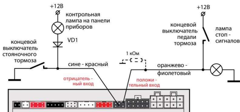
При подключении к стояночному тормозу необходимо подключить диод (VD1 - 1N4007) в разрыв штатного провода стояночного тормоза и подсоединить вход комплекса между катодом диода и концевым выключателем.
