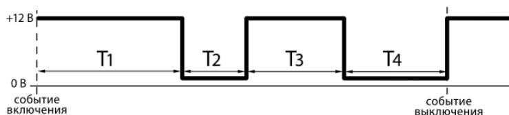
Где: Т1 - задержка первого импульса относительно события включения;
