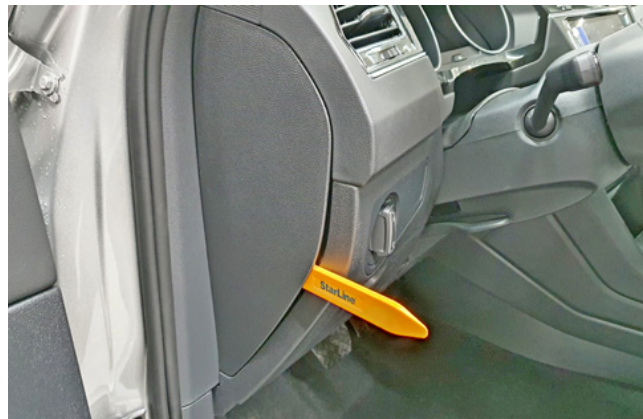
Фото 1.2. Снять боковую накладку передней панели
