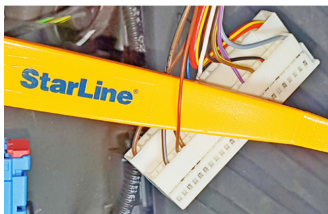
Фото 3.8. Альтернативное управление световыми сигналами (коричнево-красный)
