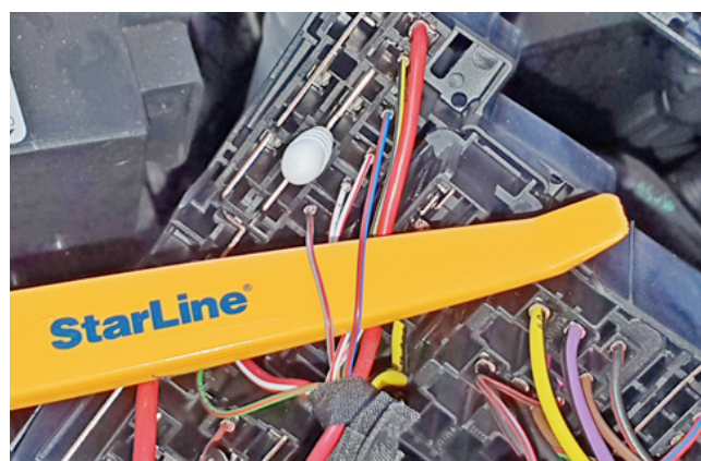
Фото 3.16. Цепи управления стартером (серо-красный и сине-красный)
