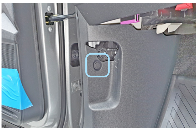
Фото 1.5. Ручка отпирания капота снята. Клипса крепления накладки левой кик-панели
