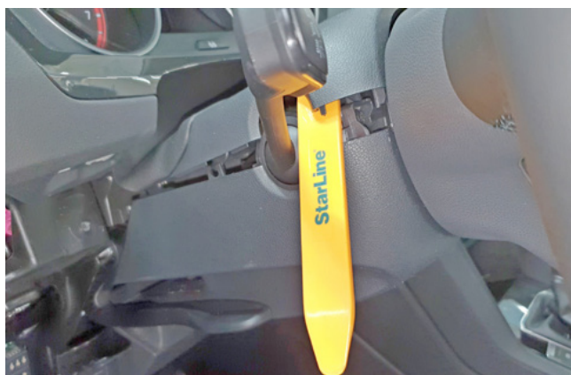
Фото 1.15. Снять верхнюю часть кожуха рулевого вала
