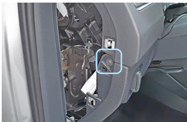
Фото 1.3. Левая боковая накладка передней панели снята. Саморез
