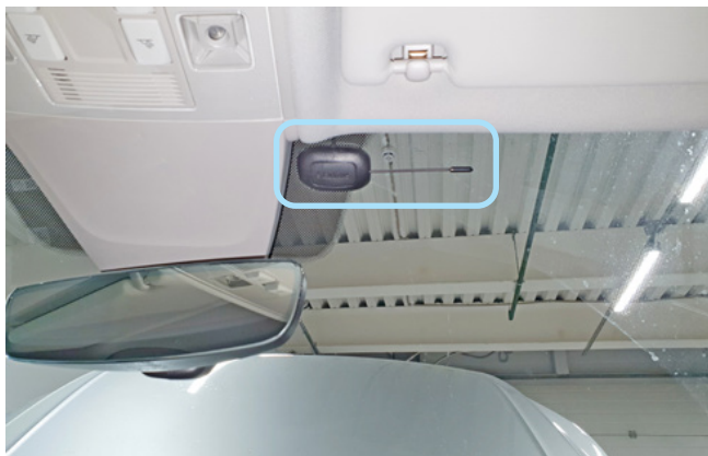
Фото 2.1. Возможное место установки антенного модуля
