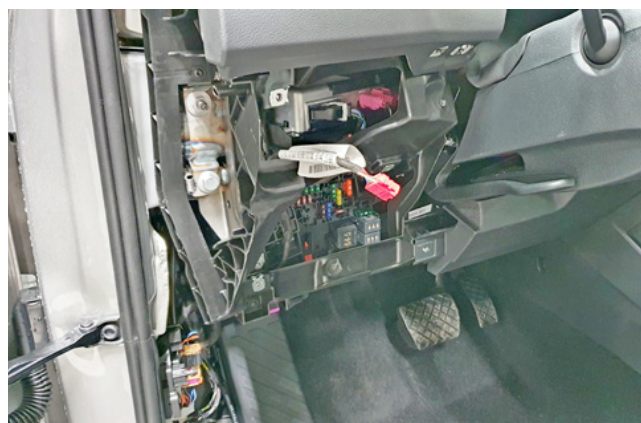
Фото 1.14. Накладка слева от рулевой колонки снята
