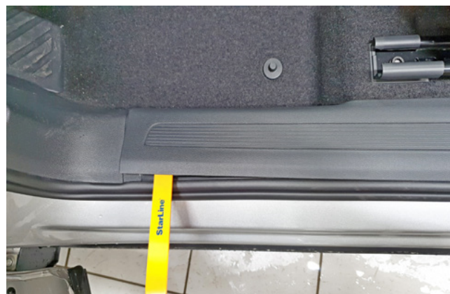
Фото 1.6. Частично снять пластиковую накладку порога двери водителя
