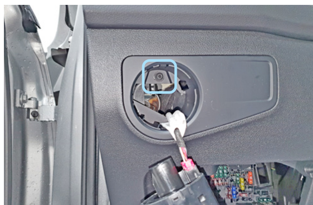
Фото 1.12. Переключатель света снят. Саморез
