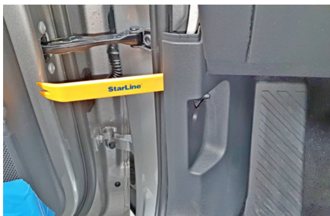
Фото 1.7. Снять пластиковую накладку левой кик-панели
