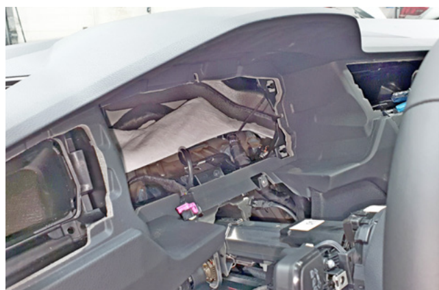
Фото 1.18. Панель приборов снята
