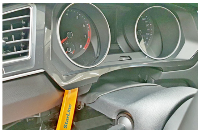
Фото 1.16. Снять декоративную накладку панели приборов
