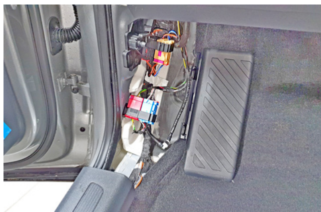
Фото 1.8. Пластиковая накладка левой кик-панели снята
