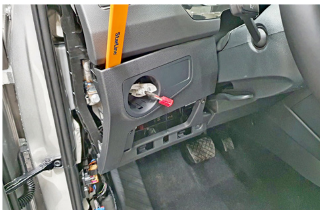
Фото 1.13. Снять накладку слева от рулевой колонки
