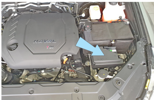
Фото 2.8. Возможное место установки подкапотного блока R6
