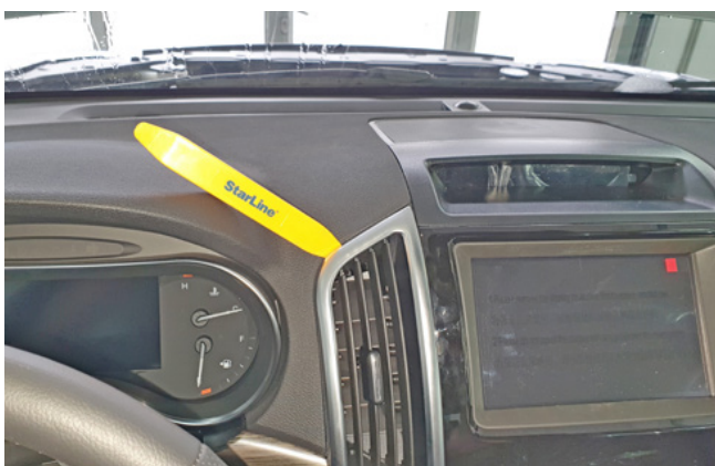
Фото 1.17. Снять воздуховод справа от панели приборов
