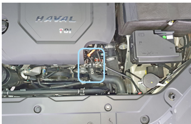
Фото 2.4. Место установки датчика температуры двигателя
