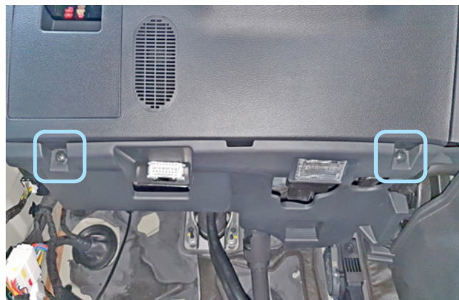
Фото 1.8. Саморезы крепления накладки педального узла
