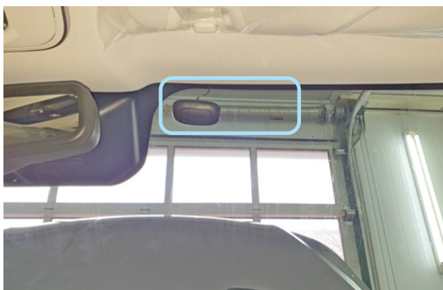
Фото 2.1. Возможное место установки антенного модуля
