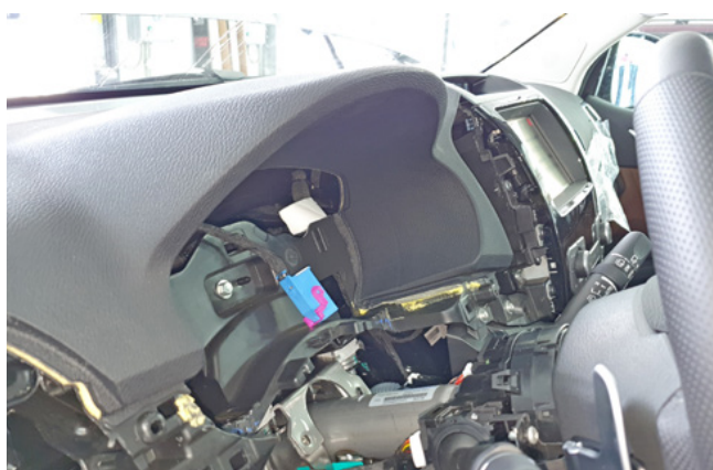
Фото 1.21. Панель приборов снята
