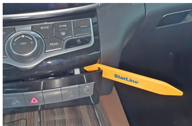
Фото 1.23. Снять блок кнопок на центральной консоли
