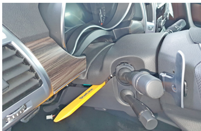
Фото 1.14. Снять верхнюю часть кожуха рулевого вала
