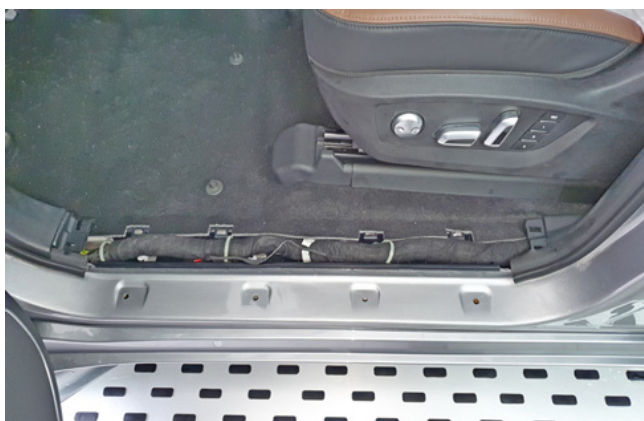
Фото 1.3. Накладка порога двери водителя снята
