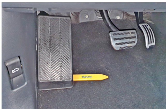
Фото 1.4. Снять упор для ноги водителя
