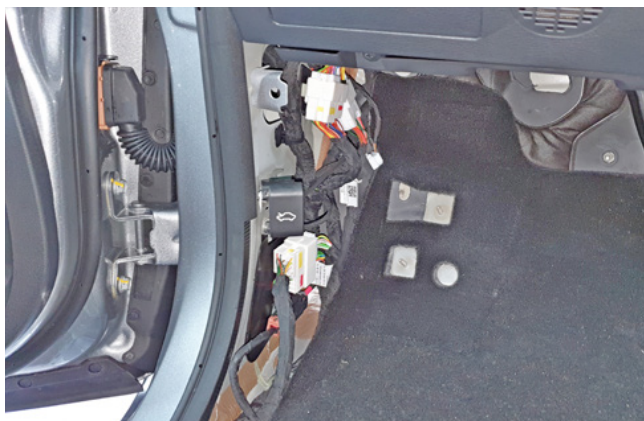
Фото 1.7. Накладка левой кик-панели снята
