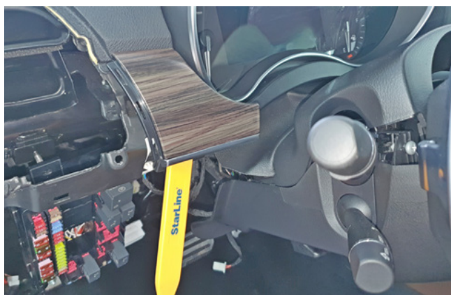
Фото 1.19. Снять декоративную накладку под панелью приборов
