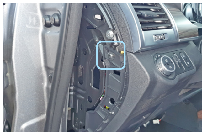
Фото 1.10. Саморез крепления пластиковой накладки под рулевой колонкой
