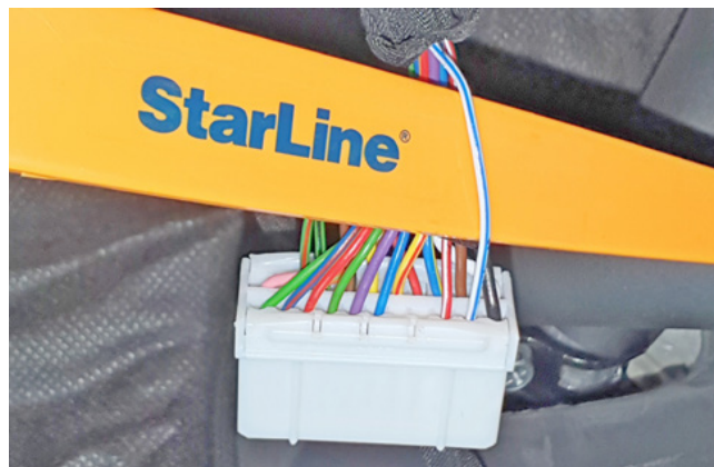
Фото 3.6. Шина данных штатного иммобилайзера (бело-синий)
