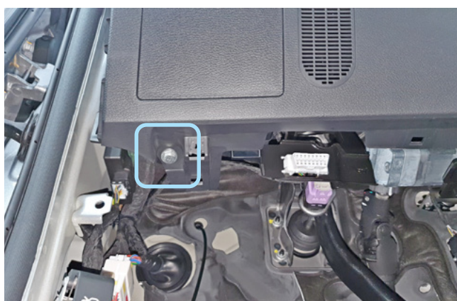
Фото 1.11. Болт в нижней части наклейки
