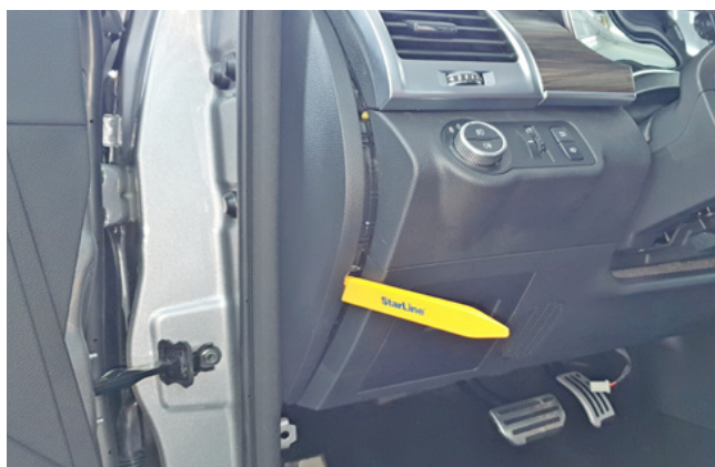
Фото 1.9. Снять боковую накладку передней панели
