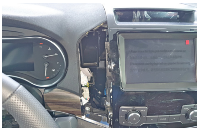
Фото 1.18. Воздуховод справа от панели приборов снят
