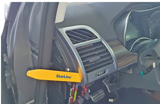
Фото 1.15. Снять воздуховод слева от панели приборов
