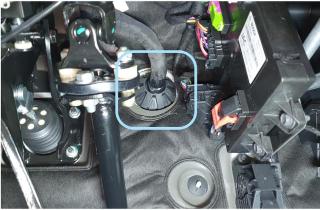
Фото 2.6. Штатный уплотнитель. Вид со стороны салона (капота)
