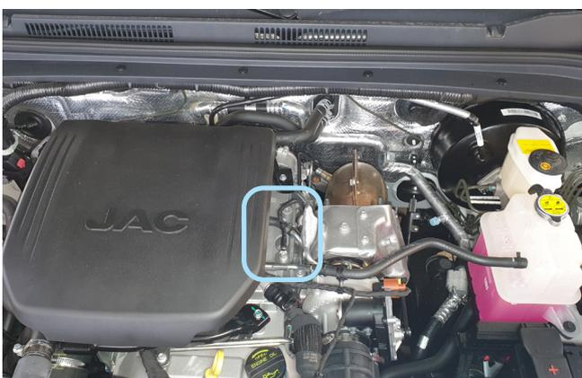
Фото 2.4. Возможное место установки датчика температуры двигателя
