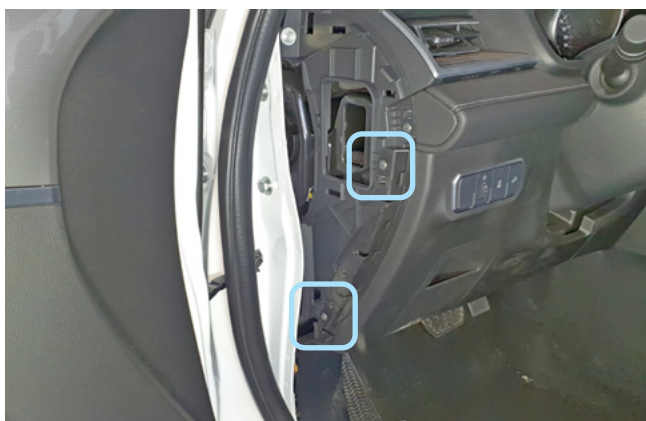
Фото 1.3. Накладка снята. Саморезы
