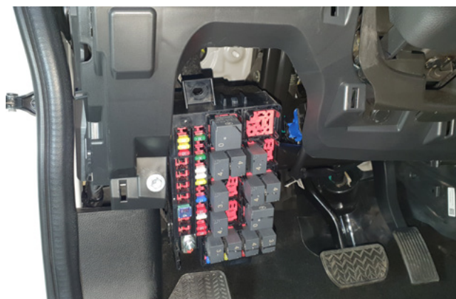
Фото 1.6. Монтажный блок предохранителей снят
