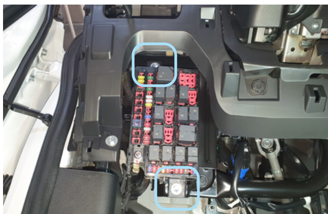
Фото 1.5. Болты крепления монтажного блока предохранителей
