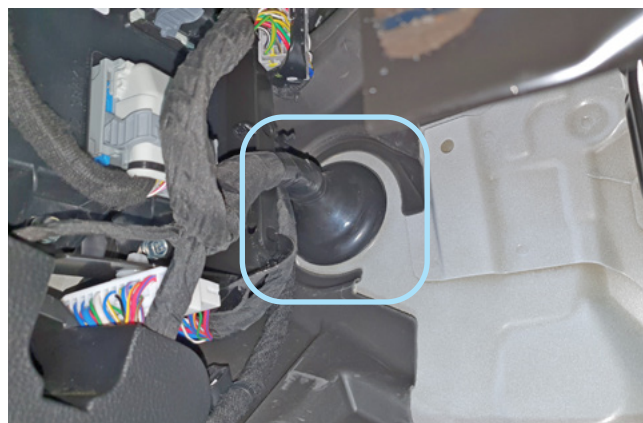
Фото 2.7. Штатный уплотнитель. Вид со стороны салона
