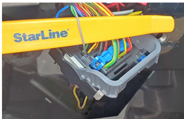
Фото 3.4. Альтернативное управление световыми сигналами (серый)
