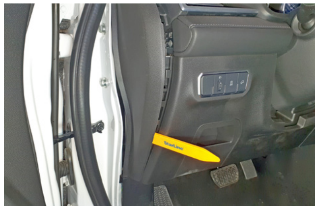
Фото 1.2. Снять боковую накладку передней панели
