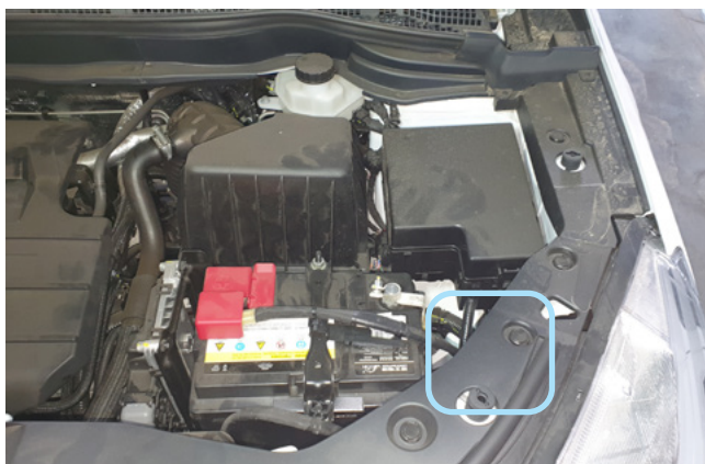
Фото 2.6. Возможное место установки концевика капота
