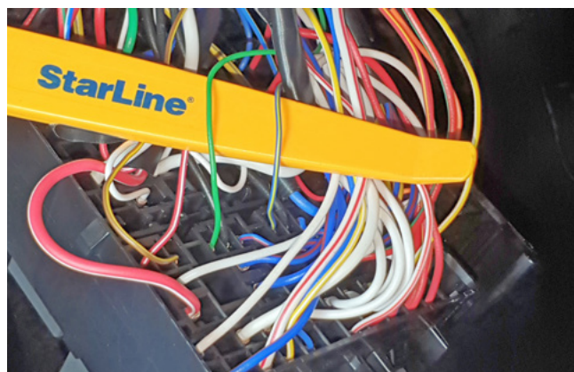
Фото 3.5. Управление центральным замком (сине-жёлтый и зелёный)
