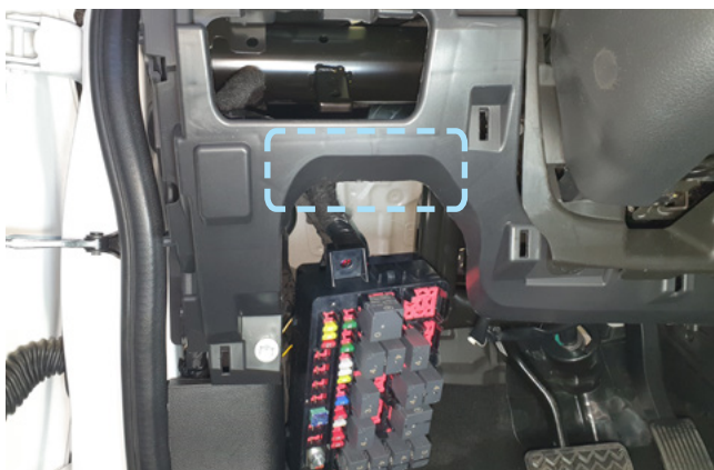
Фото 2.8. Пример расположения центрального блока охранно-телематического комплекса
