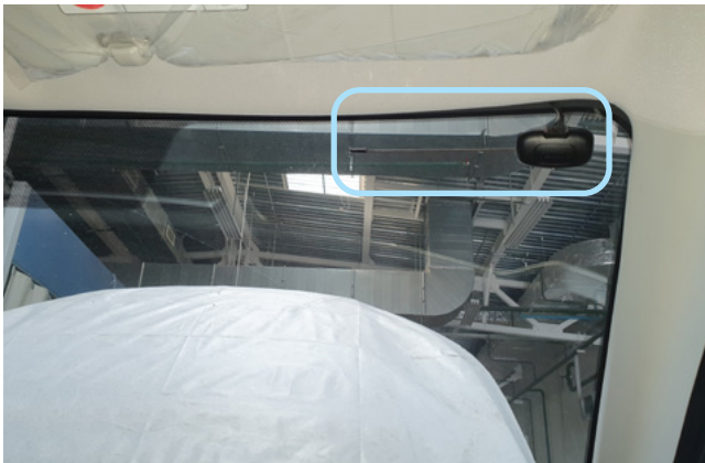
Фото 2.1. Возможное место установки антенного модуля
