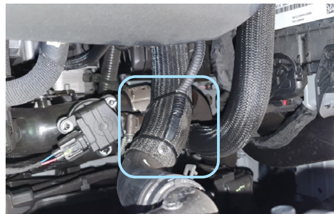
Фото 2.5. Крепление датчика температуры двигателя
