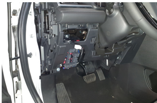
Фото 1.4. Пластиковая накладка под рулевой колонкой снята
