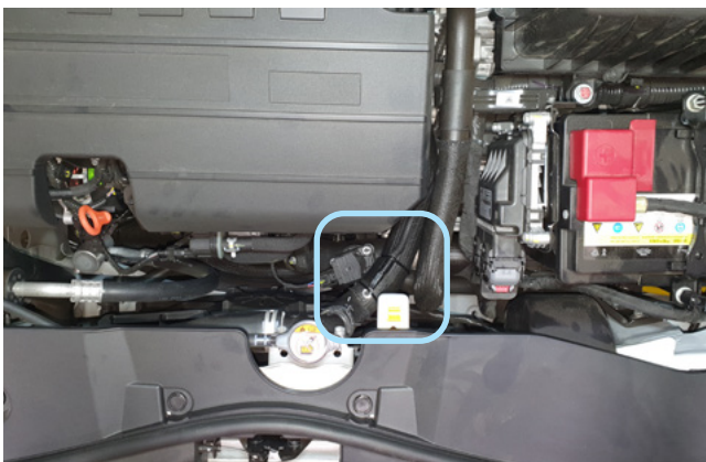
Фото 2.4. Место установки датчика температуры двигателя
