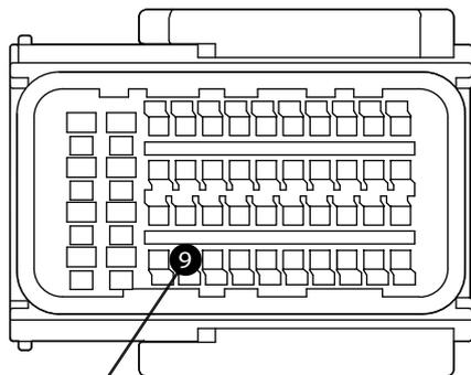
разъём IP21a блока BCM
