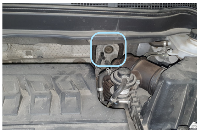
Фото 2.7. Штатный уплотнитель. Вид со стороны капота
