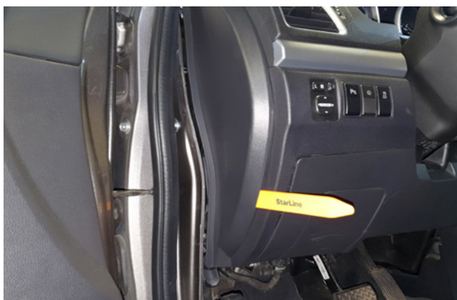
Фото 1.7. Снять боковую накладку передней панели
