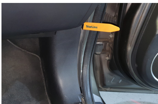
Фото 1.16. Снять накладку правой кик-панели
