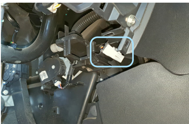
Фото 3.4. Местоположение диагностического разъёма
