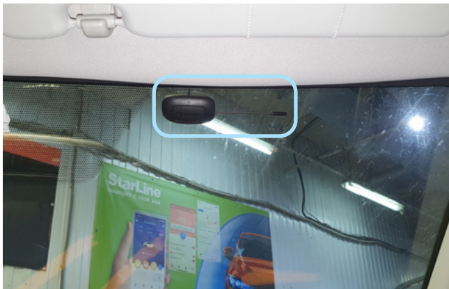
Фото 2.1. Возможное место установки антенного модуля
