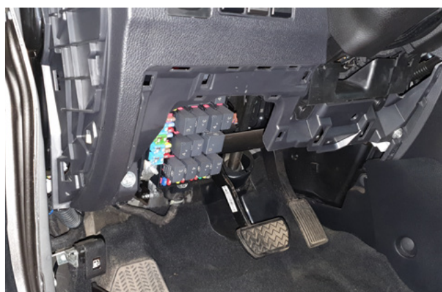
Фото 1.10. Пластиковая накладка под рулевой колонкой снята
