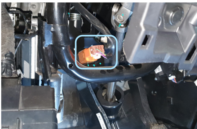
Фото 3.11. Местоположение разъёма концевика педали тормоза
