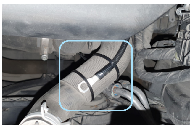
Фото 2.5. Крепление датчика температуры двигателя
