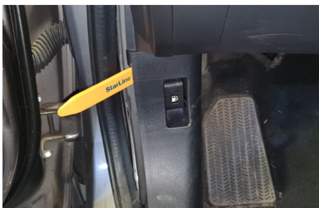
Фото 1.5. Снять накладку левой кик-панели
