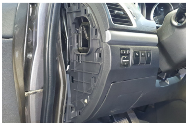
Фото 1.8. Боковая накладка передней панели снята
