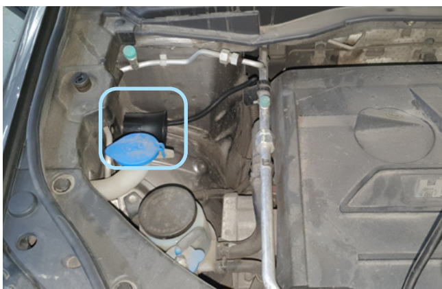
Фото 2.2. Возможное место установки сирены
