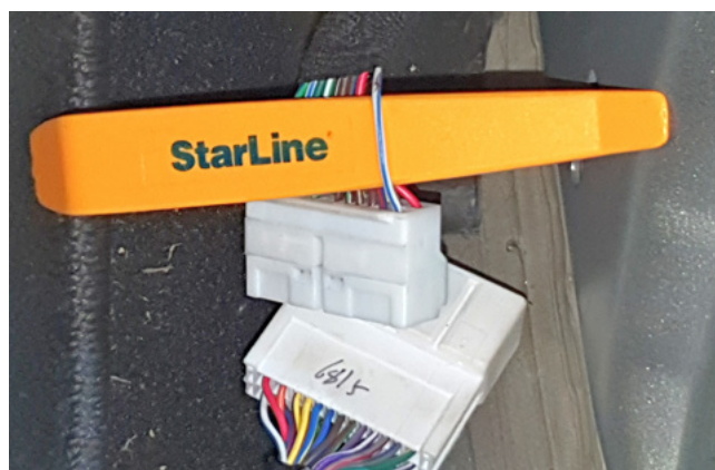
Фото 3.7. Шина данных штатного иммобилайзера (бело-синий)
