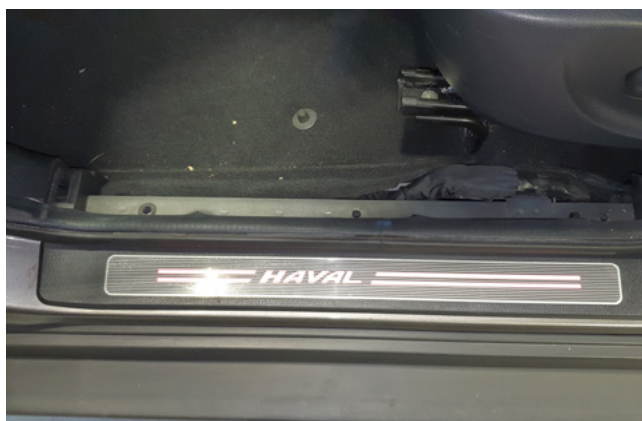
Фото 1.4. Накладка порога двери водителя снята
