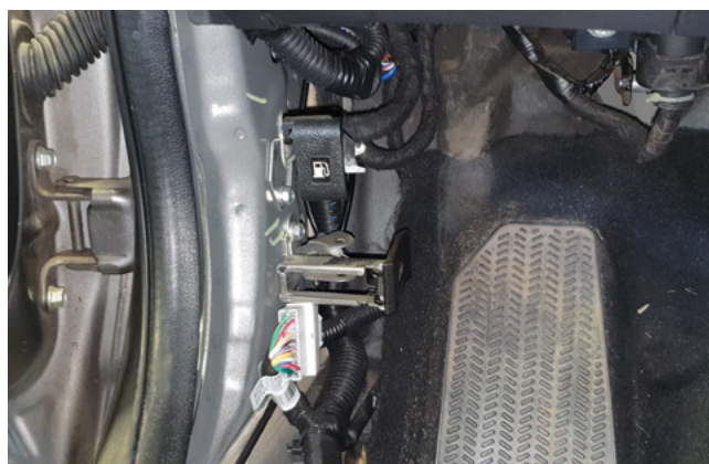
Фото 1.6. Накладка левой кик-панели снята
