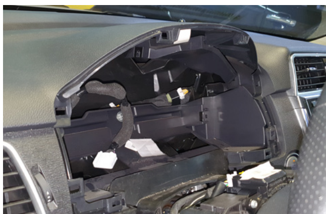
Фото 1.15. Панель приборов снята
