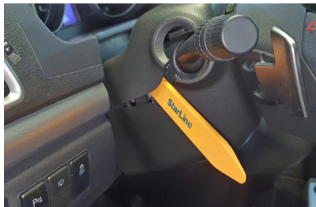
Фото 1.12. Снять верхнюю часть кожуха рулевого вала
