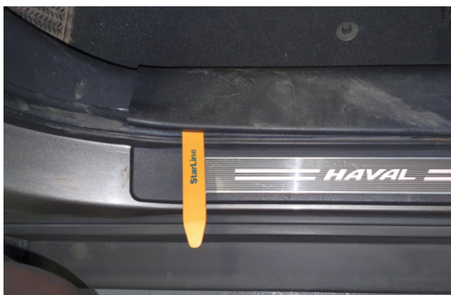
Фото 1.3. Снять накладку порога двери водителя
