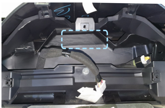
Фото 2.8. Пример расположения центрального блока охранно-телематического комплекса
