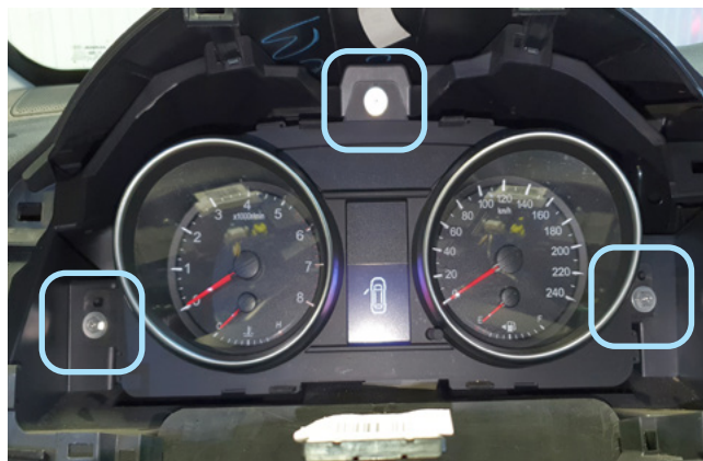
Фото 1.14. Саморезы крепления панели приборов
