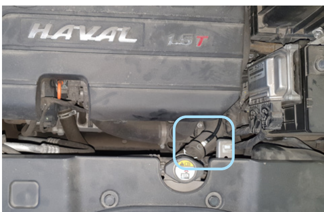
Фото 2.4. Место установки датчика температуры двигателя
