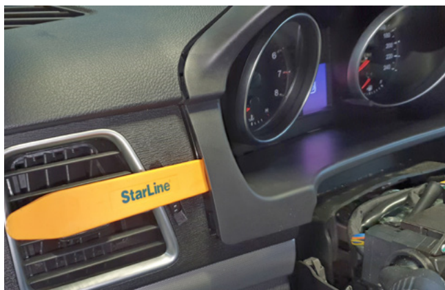
Фото 1.13. Снять декоративную накладку панели приборов
