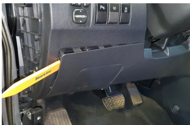
Фото 1.9. Снять пластиковую накладку под рулевой колонкой
