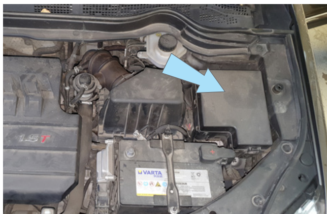
Фото 2.9. Возможное место установки подкапотного блока R6
