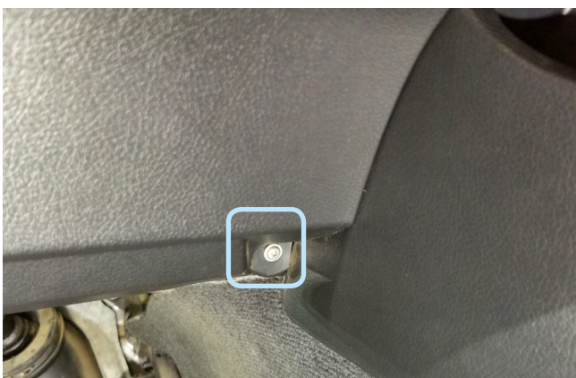
Фото 1.5. Саморез крепления накладки под рулевой колонкой
