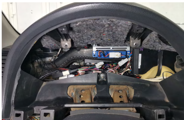
Фото 1.17. Панель приборов снята
