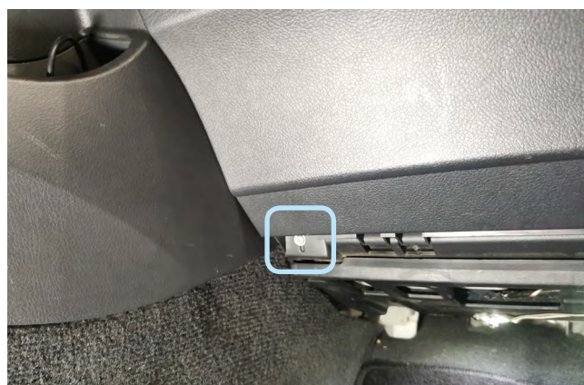
Фото 1.21. Саморез крепления перчаточного ящика
