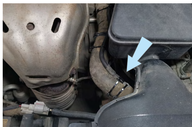
Фото 2.5. Крепление датчика температуры двигателя
