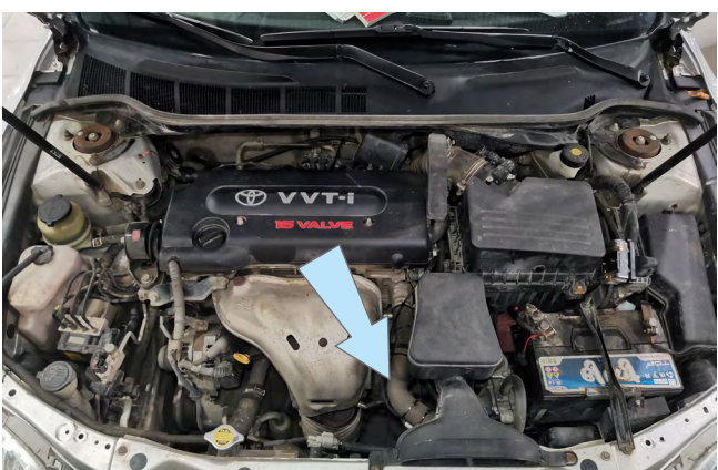
Фото 2.4. Место установки датчика температуры двигателя
