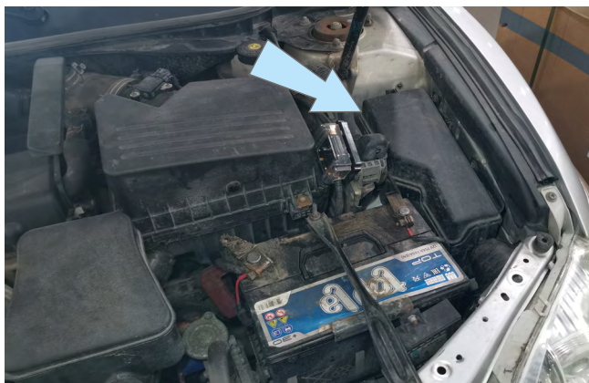
Фото 2.8. Возможное место установки подкапотного блока R6
