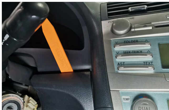
Фото 1.14. Снять накладку с права от рулевой колонки
