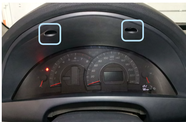
Фото 1.15. Клипсы крепления накладки панели приборов
