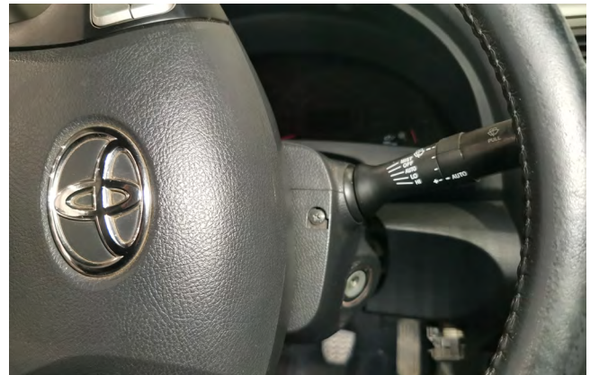
Фото 1.10. Саморез крепления кожуха справа
