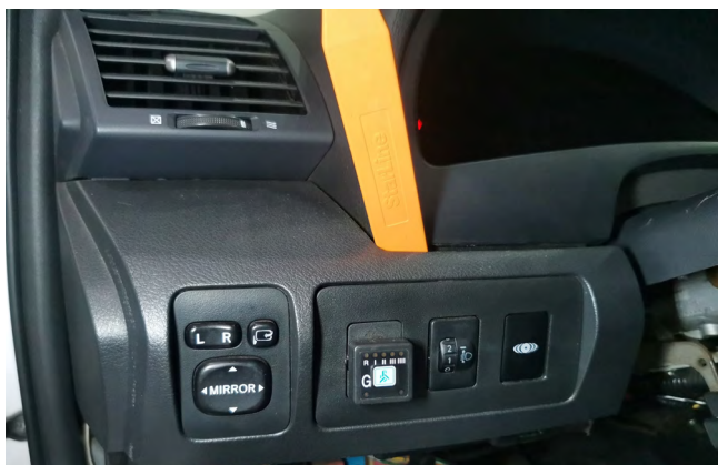
Фото 1.13. Снять накладку с лева от рулевой колонки
