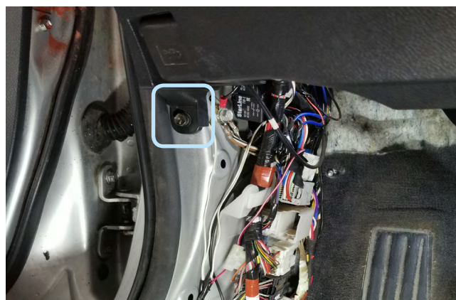
Фото 1.6. Болт крепления накладки под рулевой колонкой
