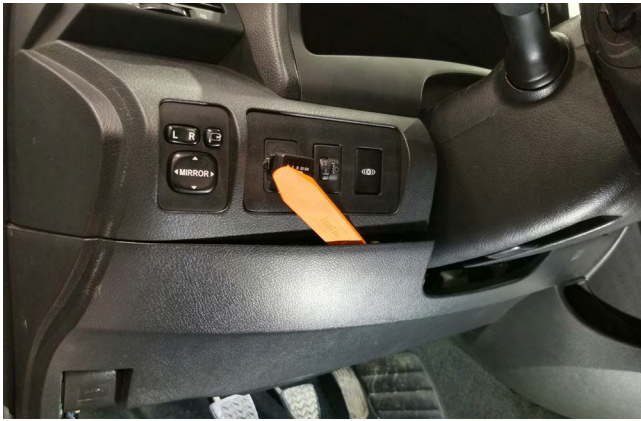
Фото 1.7. Снять накладку под рулевой колонкой
