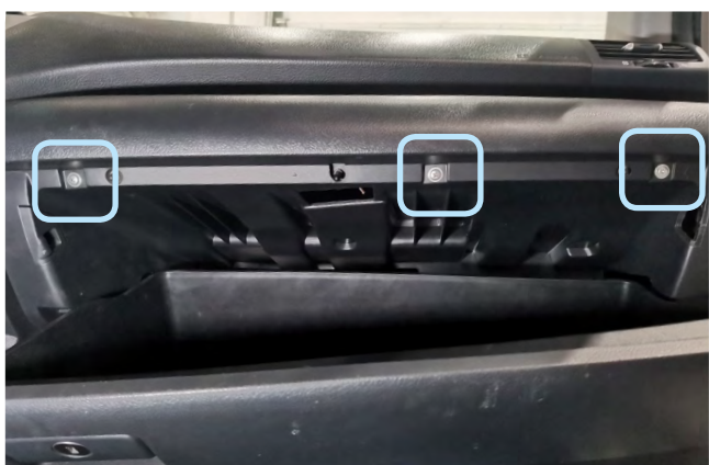
Фото 1.22. Саморезы крепления перчаточного ящика
