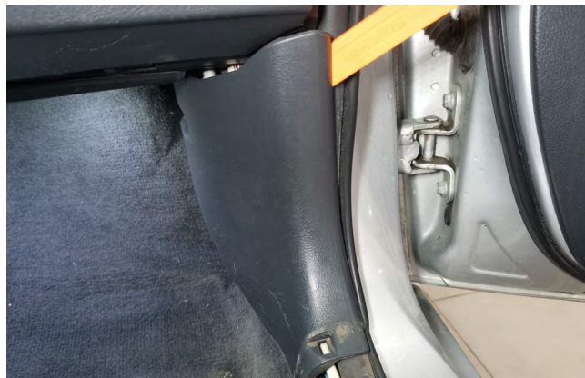
Фото 1.19. Снять правую кик-панель
