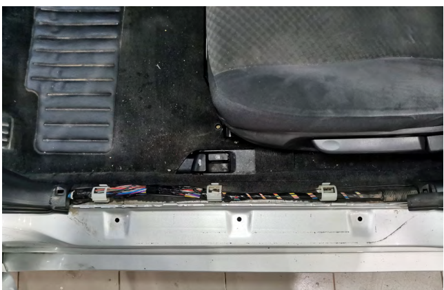
Фото 1.3. Накладка порога водителя снята
