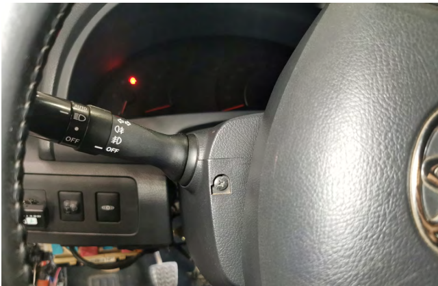
Фото 1.9. Саморез крепления кожуха слева
