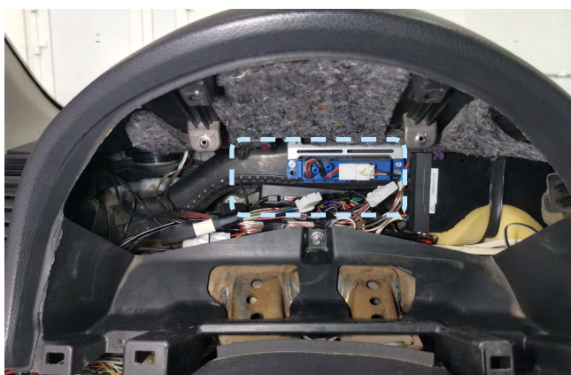
Фото 2.7. Пример расположения центрального блока охранно-телематического комплекса
