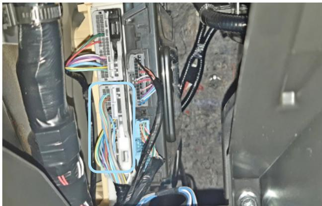
Фото 3.11. Местоположение разъёма на блоке BCM
