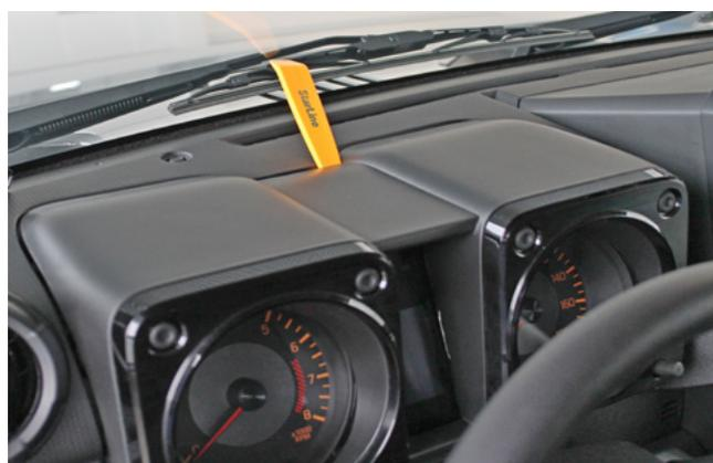
Фото 1.5. Снять декоративную накладку панели приборов
