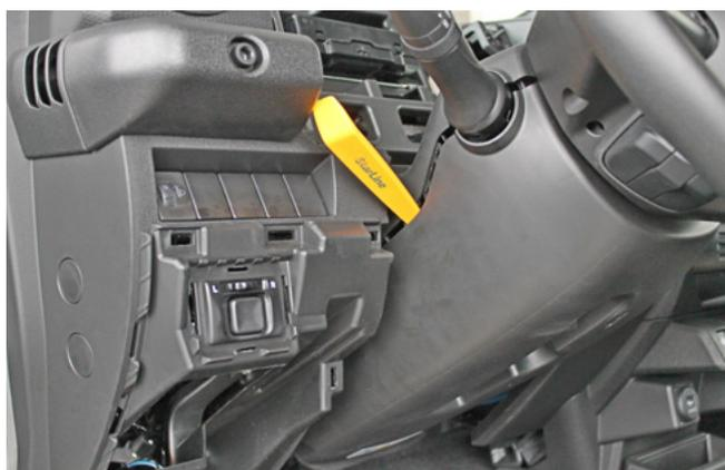
Фото 1.10. Снять нижнюю часть кожуха рулевого вала
