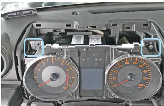
Фото 1.6. Накладка снята. Саморезы крепления
