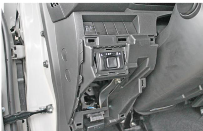
Фото 1.3. Пластиковая накладка слева от рулевой колонки снята
