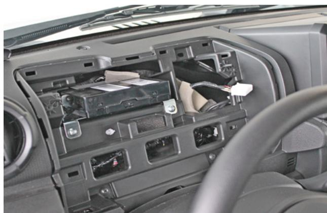
Фото 1.7. Панель приборов снята
