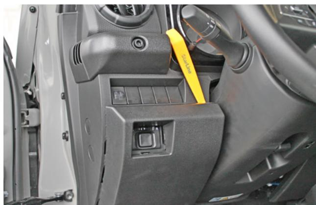
Фото 1.2. Снять пластиковую накладку слева от рулевой колонки
