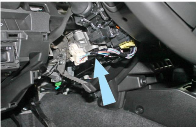
Фото 3.7. Местоположение жгута разъёма замка зажигания
