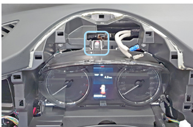
Фото 1.17. Накладка снята. Саморез крепления панели приборов
