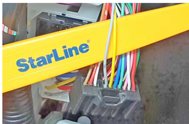
Фото 3.7. Управление центральным замком (серый и жёлтый)
