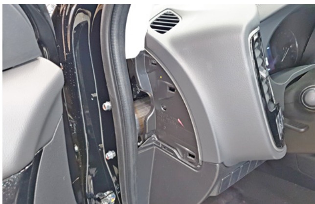
Фото 1.9. Боковая накладка передней панели снята
