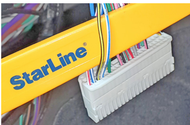
Фото 3.4. Шина CAN-B (бело-синий и чёрно-жёлтый)
