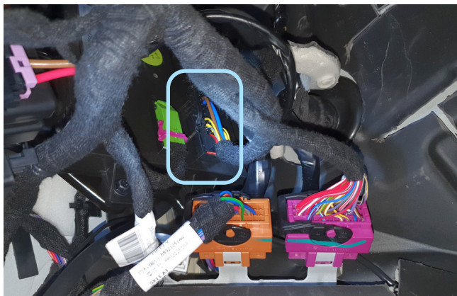
Фото 3.1. Местоположение разъёма J3
