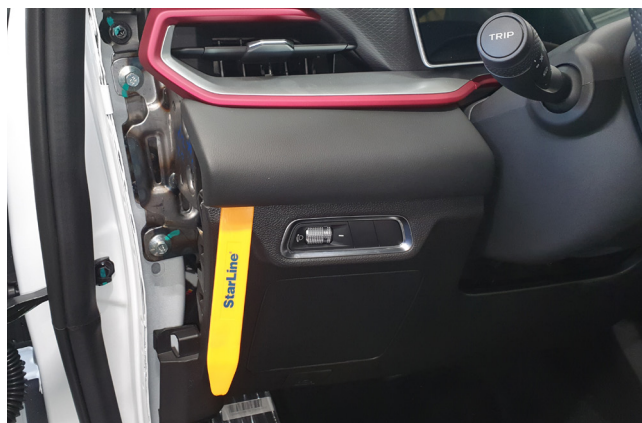
Фото 1.8. Снять накладку под левым воздуховодом
