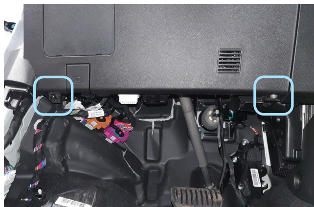
Фото 1.10. Крепление накладки под рулевой колонкой
