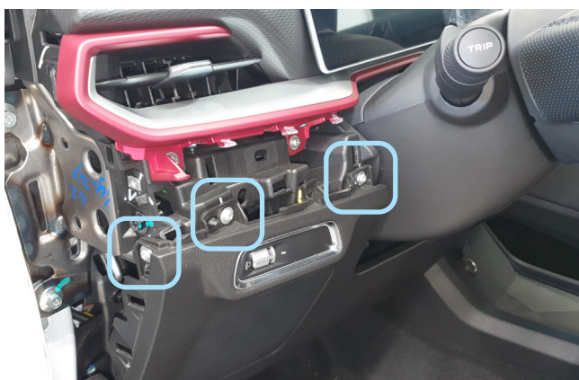
Фото 1.9. Накладка снята. Саморезы
