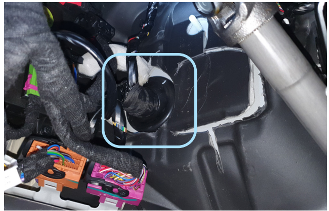
Фото 2.6. Штатный уплотнитель. Вид со стороны салона
