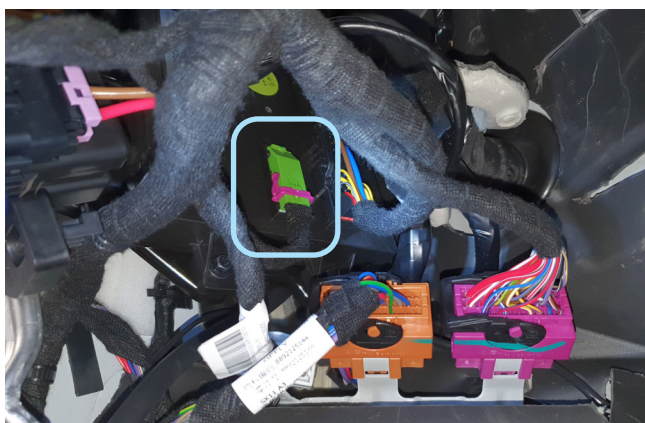
Фото 3.9. Местоположение разъёма J4
