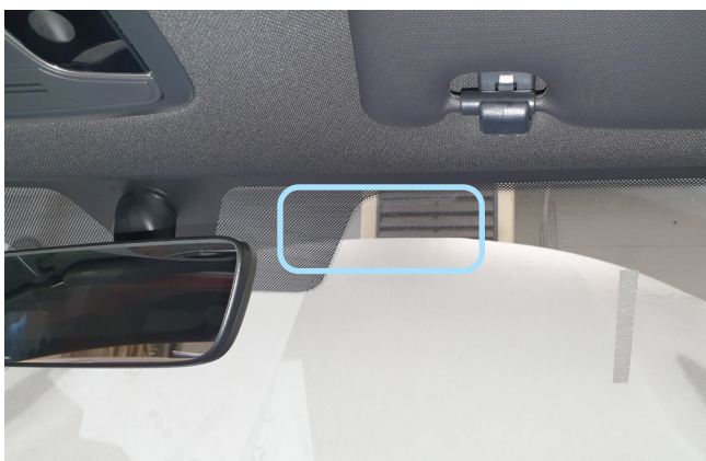
Фото 2.1. Возможное место установки антенного модуля
