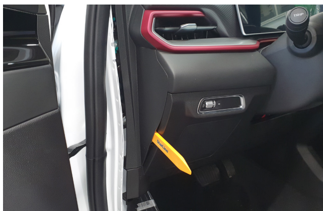
Фото 1.6. Снять боковую накладку передней панели
