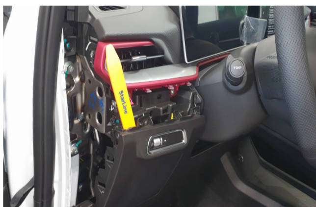
Фото 1.11. Снять пластиковую накладку под рулевой колонкой
