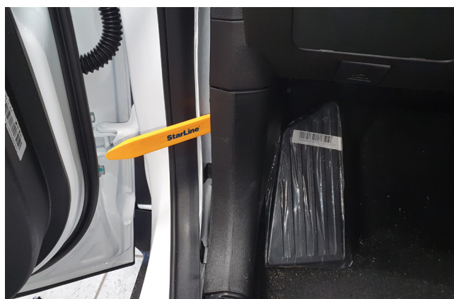
Фото 1.4. Снять накладку левой кик-панели
