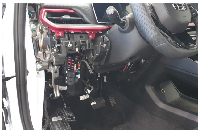
Фото 1.12. Пластиковая накладка под рулевой колонкой снята
