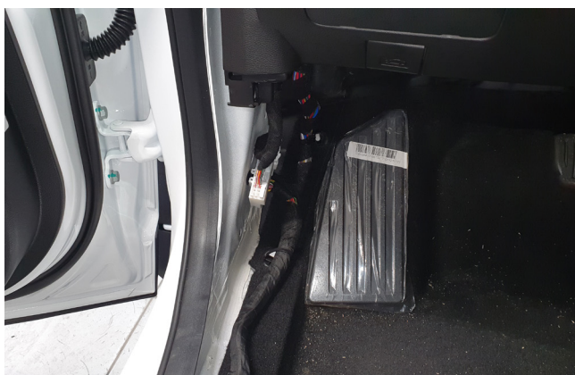
Фото 1.5. Накладка левой кик-панели снята
