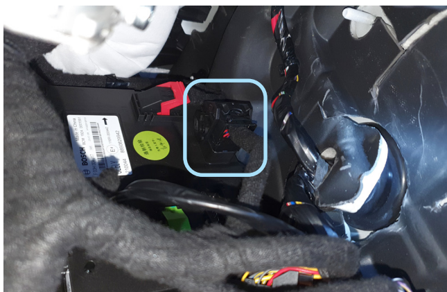
Фото 3.12. Местоположение разъёма J2
