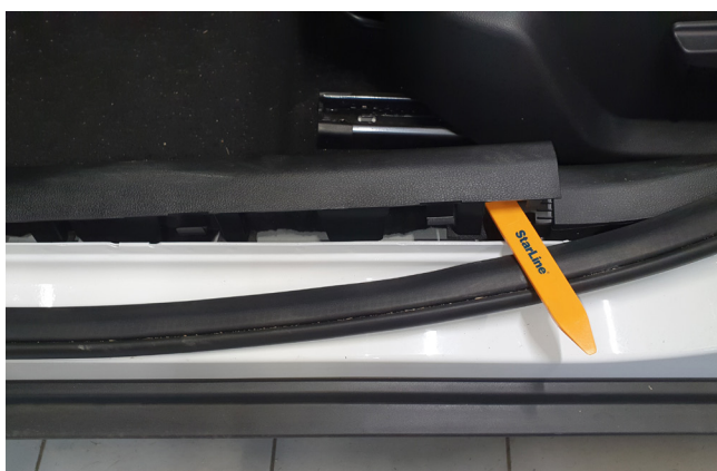
Фото 1.3. Снять накладку порога двери водителя
