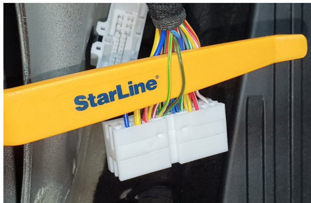
Фото 3.6. Шина CAN-B (жёлто-зелёный и зелёно-красный)
