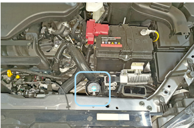
Фото 2.4. Возможное место установки сирены
