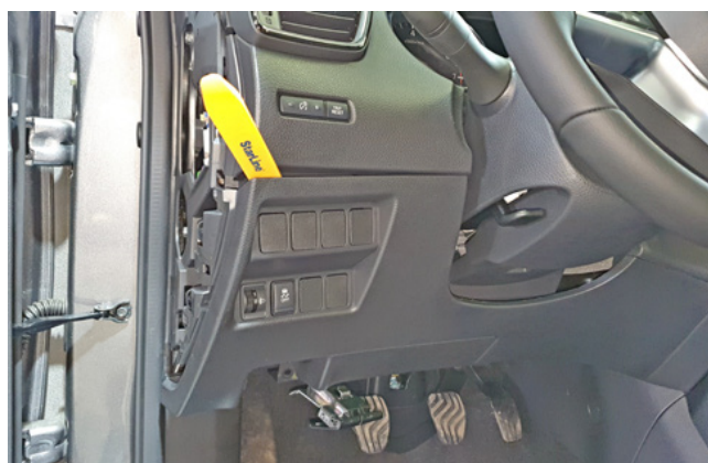
Фото 1.4. Снять пластиковую накладку под рулевой колонкой
