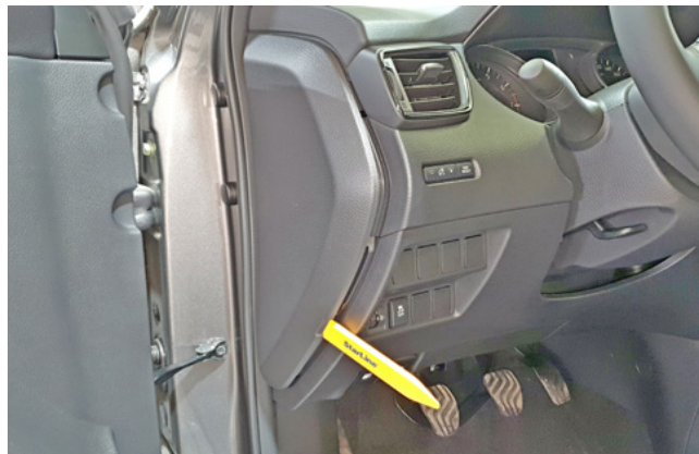
Фото 1.2. Снять боковую накладку передней панели
