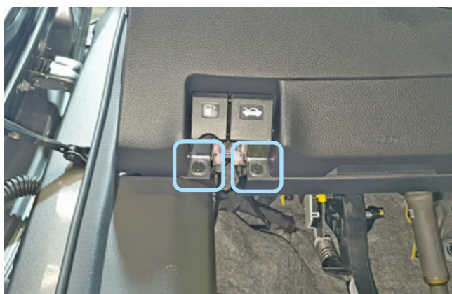
Фото 1.3. Болты крепления ручки отпирания капота
