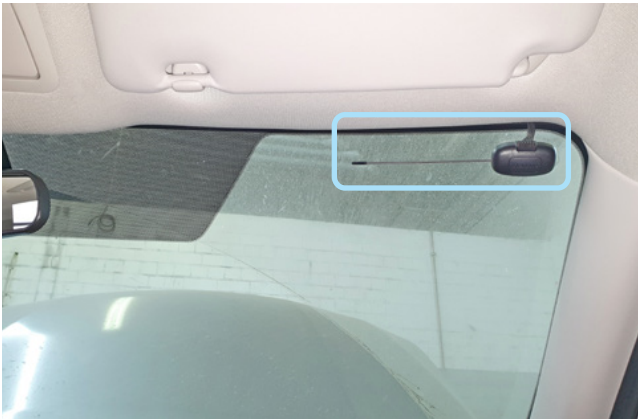
Фото 2.1. Возможное место установки антенного модуля
