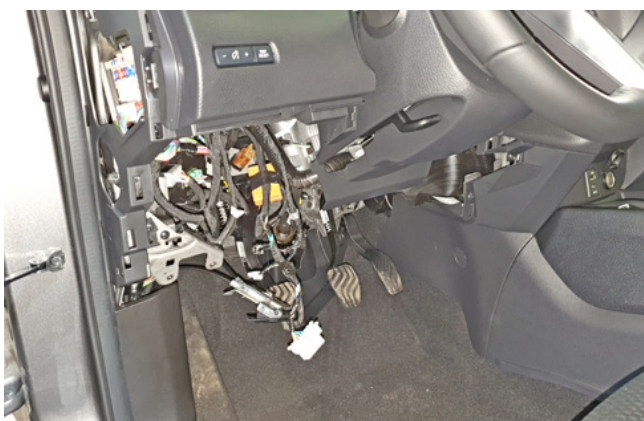
Фото 1.5. Пластиковая накладка под рулевой колонкой снята
