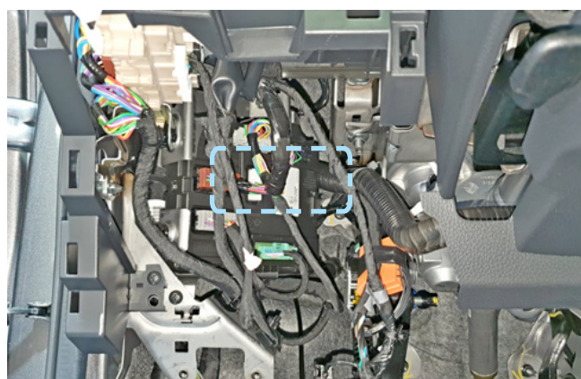
Фото 2.10. Пример расположения центрального блока охранно-телематического комплекса
