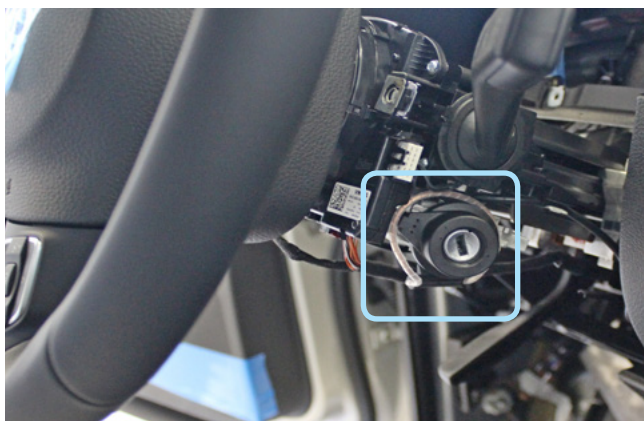
Фото 3.16. Антенна модуля обхода штатного иммобилайзера на замке зажигания
