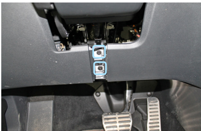
Фото 1.9. Пластиковая заглушка под рулевой колонкой снята. Саморезы
