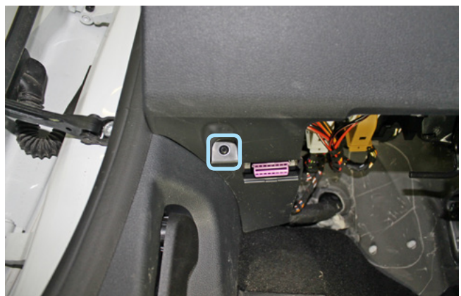
Фото 1.10. Саморез крепления пластиковой наклейки
