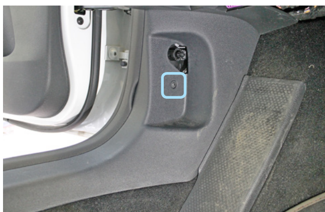
Фото 1.26. Ручка отпирания капота снята. Саморез крепления
