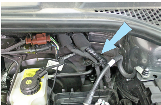
Фото 3.8. Местоположение жгута за аккумуляторной батареей на автомобилях с функцией Стоп-Старт
