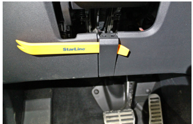
Фото 1.8. Снять пластиковую заглушку под рулевой колонкой
