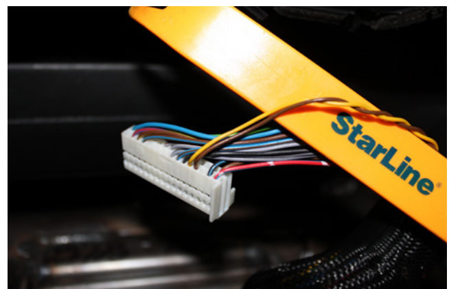
Фото 3.5. Шина CAN-B (коричневый и жёлтый)
