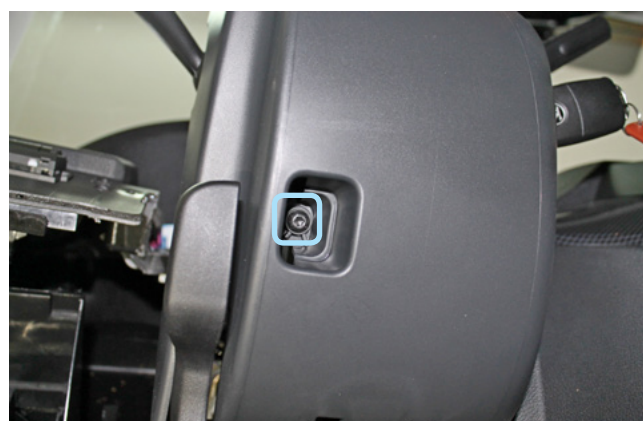
Фото 1.22. Винт крепления нижней части кожуха рулевого вала снизу
