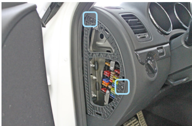
Фото 1.3. Боковая накладка передней панели снята. Саморезы
