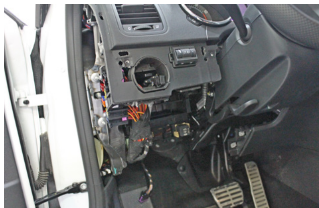
Фото 1.12. Пластиковая накладка под рулевой колонкой снята
