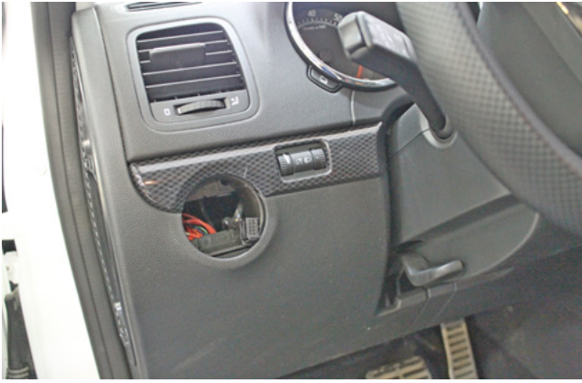
Фото 1.5. Переключатель света снят
