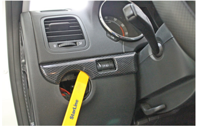
Фото 1.6. Снять пластиковую накладку над переключателем света
