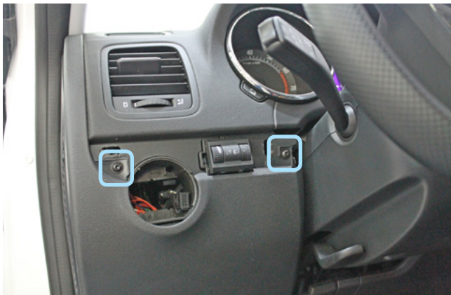
Фото 1.7. Пластиковая накладка над переключателем света снята. Саморезы
