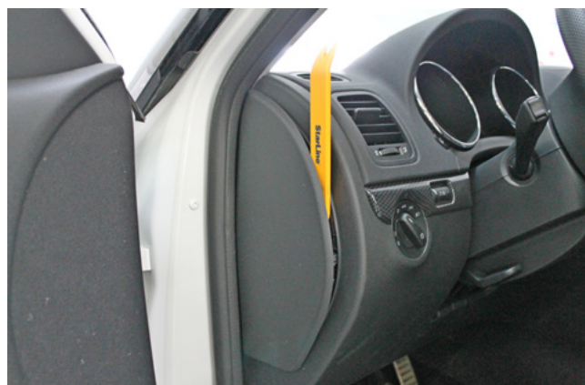
Фото 1.2. Снять левую боковую накладку передней панели
