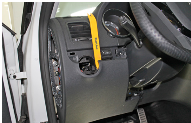
Фото 1.11. Снять пластиковую накладку под рулевой колонкой
