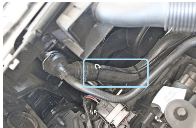
Фото 2.4. Крепление датчика температуры двигателя
