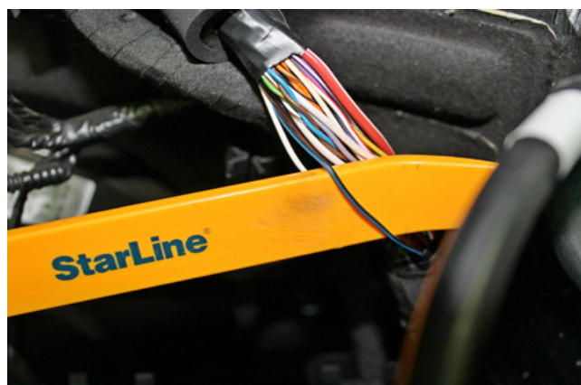
Фото 2.9. Подключение цепи зажигания (чёрно-синий)
