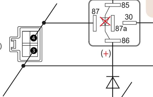
Обязательно удалите диод (если он установлен в колодке реле)
