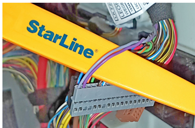
Фото 3.13. Провода антенны штатного иммобилайзера (серый и фиолетовый)
