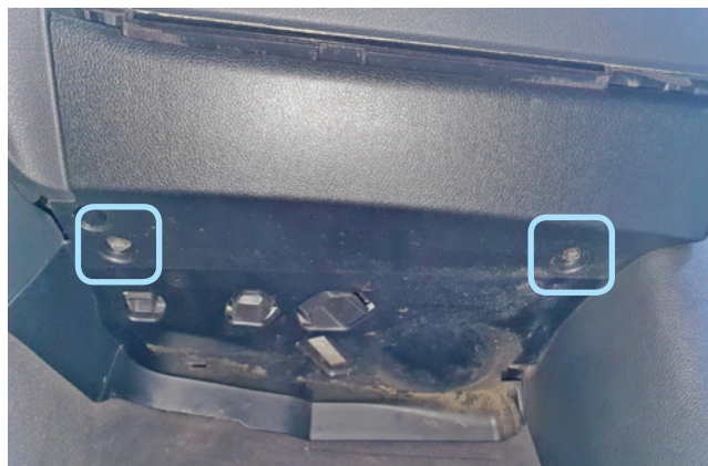
Фото 1.2. Болты крепления пластиковой накладки под перчаточным ящиком
