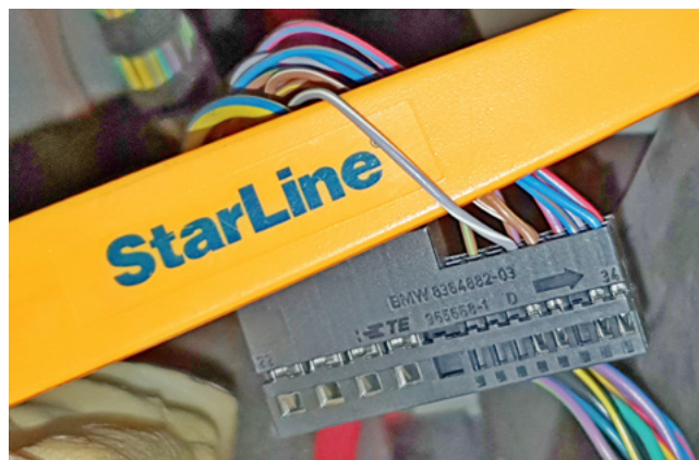
Фото 3.11. Концевик двери водителя (серо-белый)
