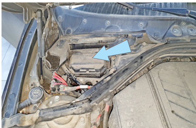
Фото 2.6. Возможное место установки подкапотного блока R6
