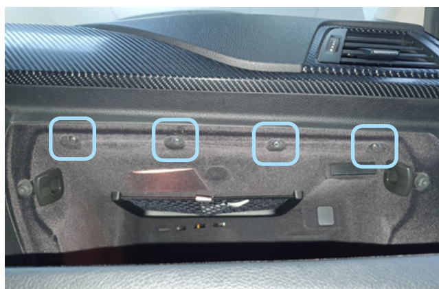
Фото 1.4. Саморезы крепления перчаточного ящика сверху
