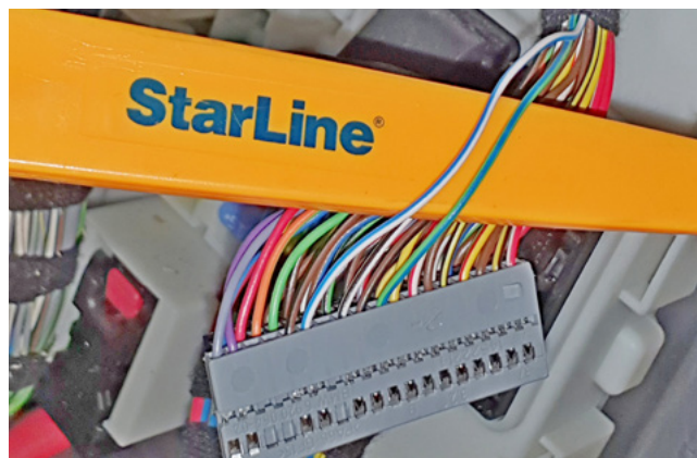
Фото 3.7. Управление кнопкой Старт-Стоп (бело-синий и зелёно-синий)
