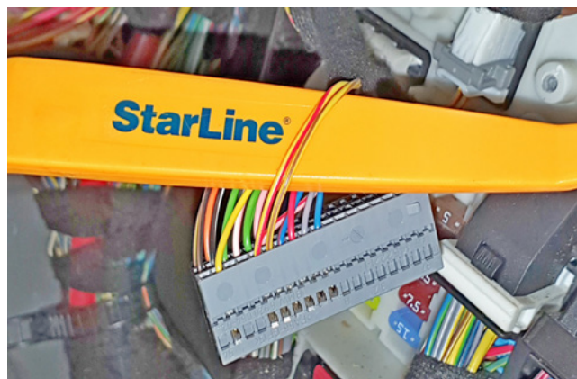
Фото 3.4. Шина CAN-A (жёлто-красный и жёлто-коричневый)
