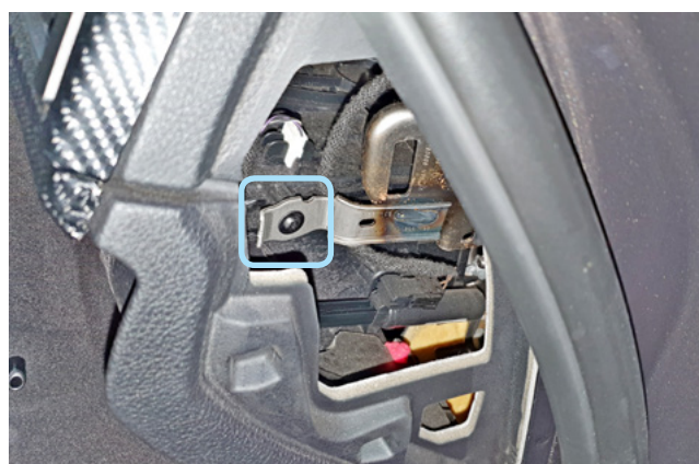
Фото 1.10. Накладка снята. Саморез
