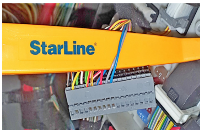
Фото 3.5. Шина CAN-B (серый и синий)
