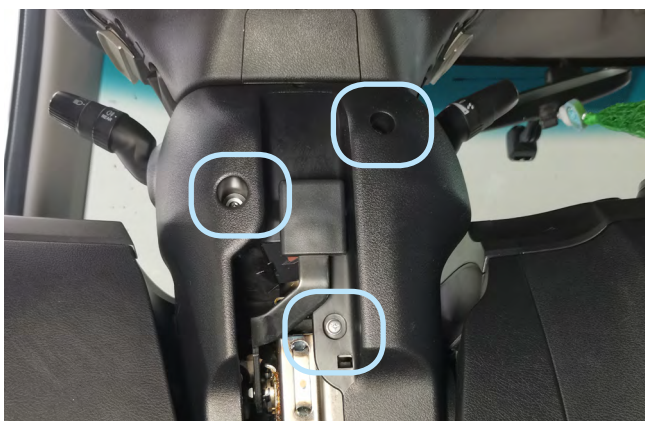
Фото1.3. Саморезы крепления кожуха рулевого вала
