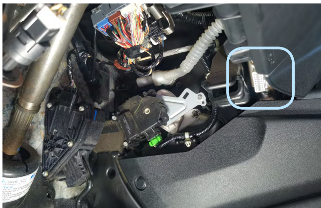
Фото 3.4. Местоположение диагностического разъёма
