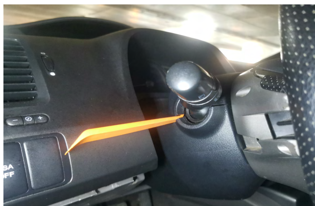
Фото1.4. Снять накладку кожуха рулевого вала
