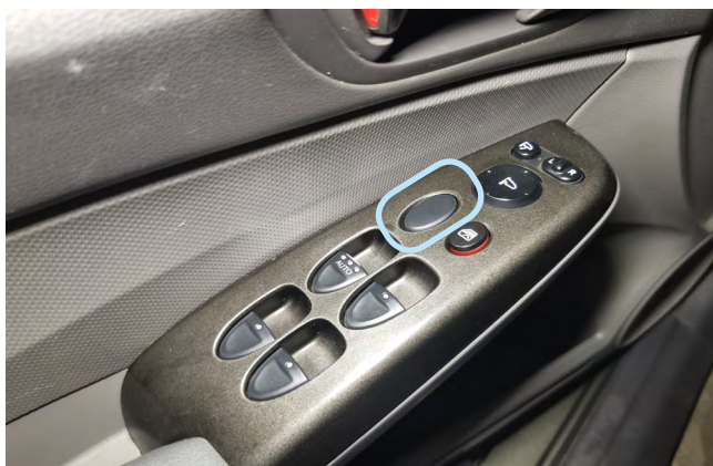
Фото 3.6. Кнопка ЦЗ отсутствует
