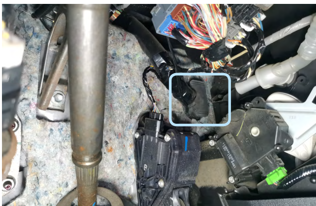
Фото 2.6. Штатный уплотнитель. Вид со стороны салона
