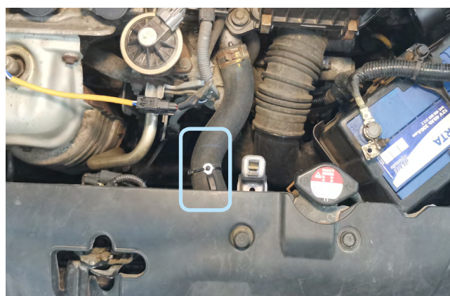
Фото 2.5. Крепление датчика температуры двигателя
