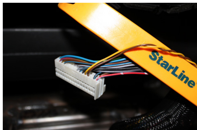
Фото 3.5. Шина CAN-B (коричневый и жёлтый)
