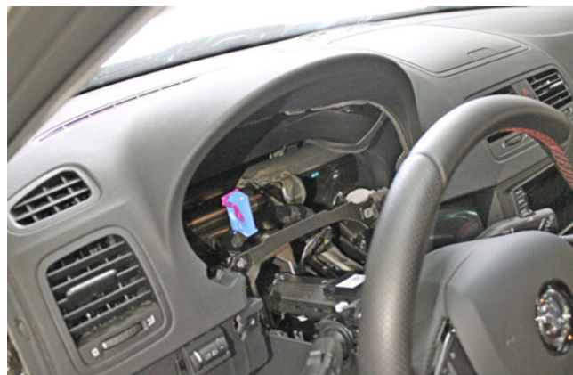
Фото 1.18. Панель приборов снята
