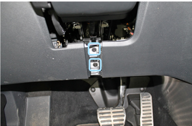
Фото 1.9. Пластиковая заглушка под рулевой колонкой снята. Саморезы
