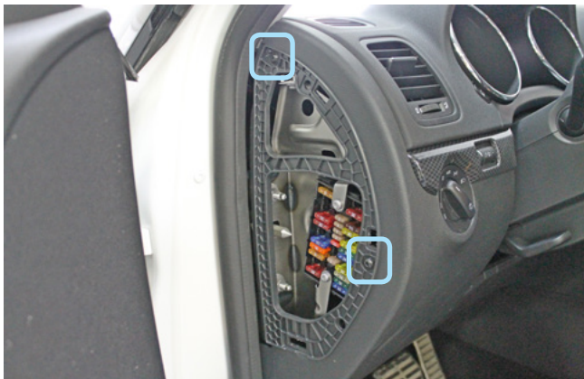
Фото 1.3. Боковая накладка передней панели снята. Саморезы
