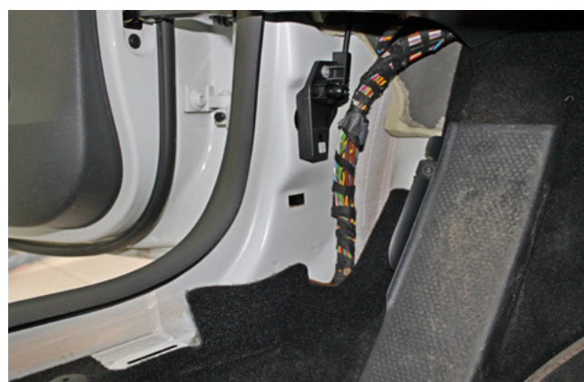
Фото 1.27. Накладка левой кик-панели снята
