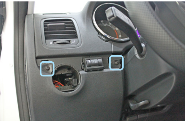
Фото 1.7. Пластиковая накладка над переключателем света снята. Саморезы
