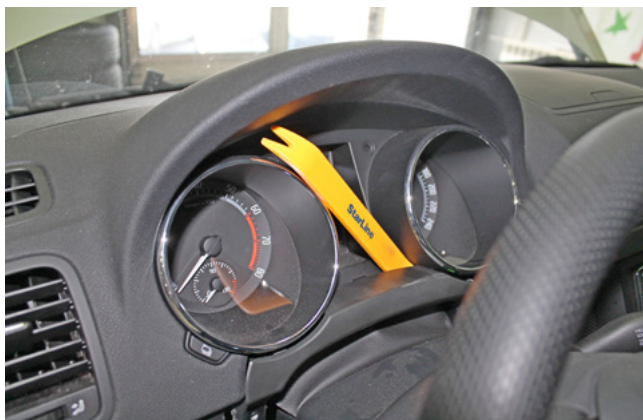
Фото 1.14. Снять декоративную накладку снизу панели приборов
