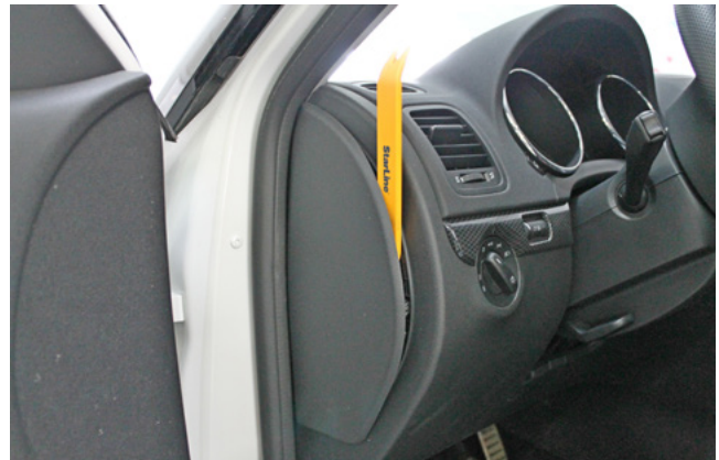
Фото 1.2. Снять левую боковую накладку передней панели
