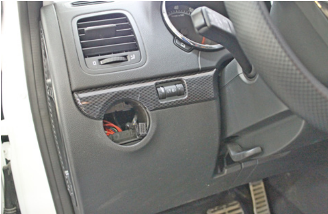
Фото 1.5. Переключатель света снят
