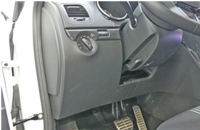
Фото 1.1. Пластиковая накладка под рулевой колонкой. Общий вид
