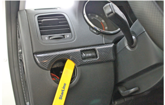
Фото 1.6. Снять пластиковую накладку над переключателем света
