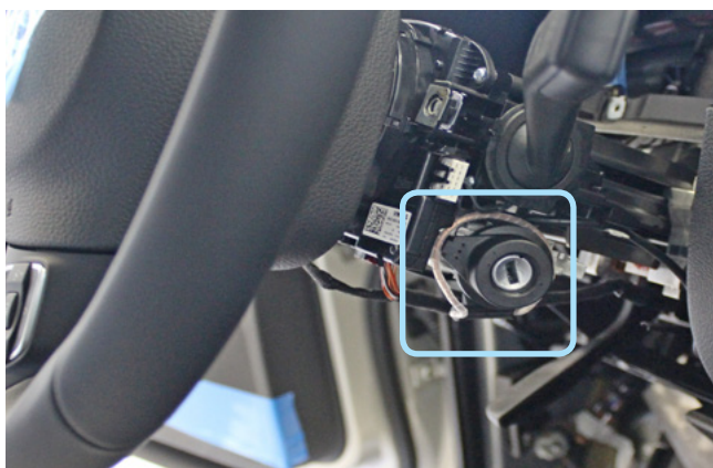
Фото 3.18. Антенна модуля обхода штатного иммобилайзера на замке зажигания
