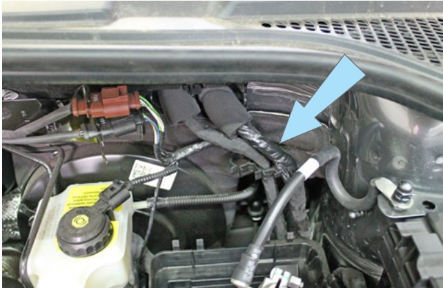
Фото 3.10. Местоположение жгута за аккумуляторной батареей на автомобилях с функцией Стоп-Старт
