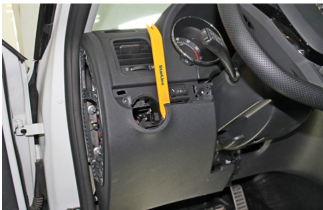
Фото 1.11. Снять пластиковую накладку под рулевой колонкой
