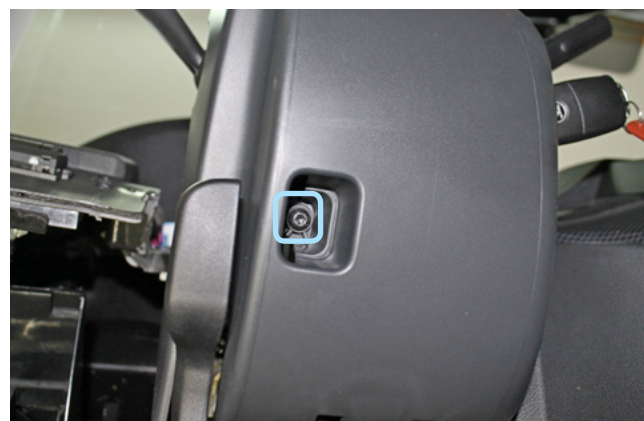
Фото 1.22. Винт крепления нижней части кожуха рулевого вала снизу
