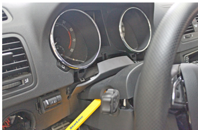
Фото 1.16. Снять верхнюю часть кожуха рулевого вала
