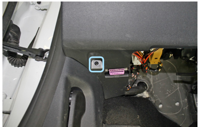
Фото 1.10. Саморез крепления пластиковой наклейки
