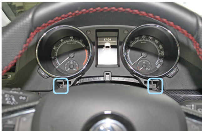
Фото 1.17. Саморезы крепления панели приборов
