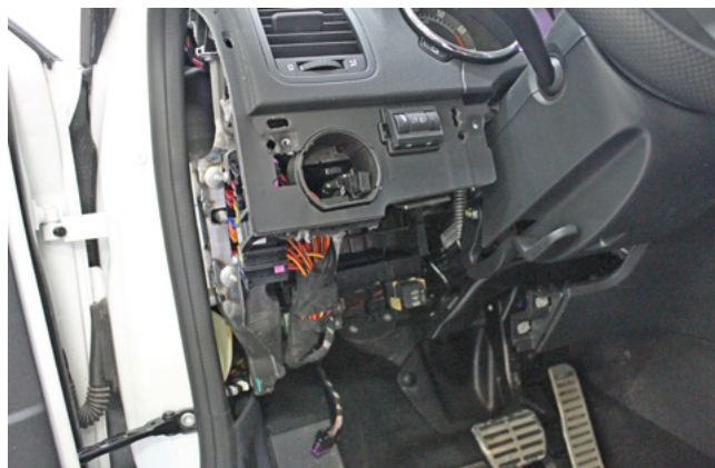
Фото 1.12. Пластиковая накладка под рулевой колонкой снята
