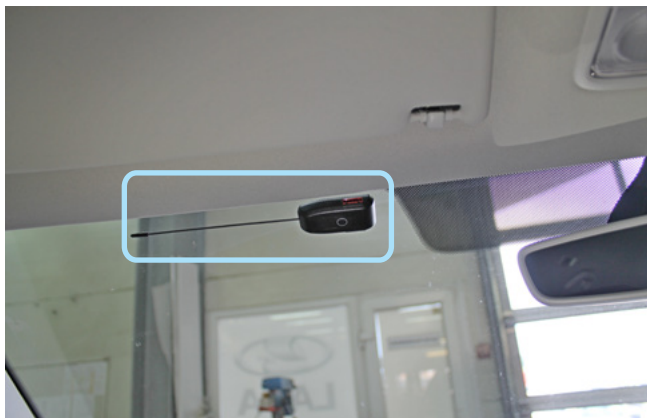
Фото 2.1. Возможное место установки антенного модуля
