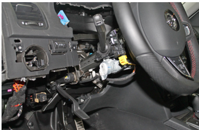
Фото 1.23. Нижняя часть кожуха рулевого вала снята
