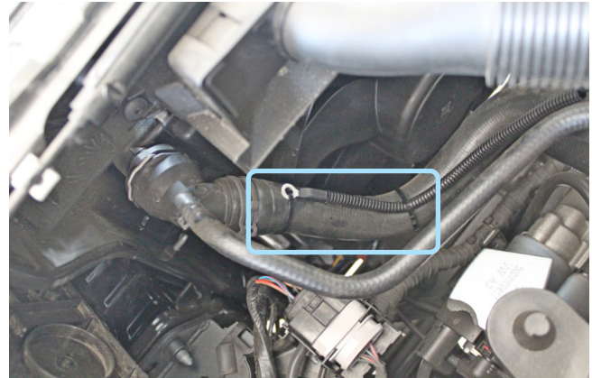
Фото 2.6. Крепление датчика температуры двигателя
