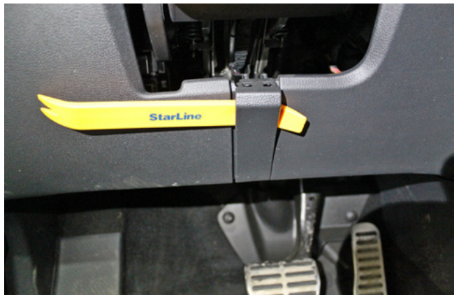
Фото 1.8. Снять пластиковую заглушку под рулевой колонкой
