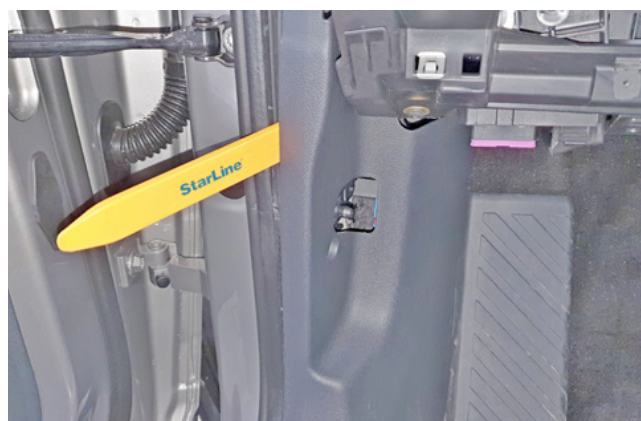
Фото 1.16. Снять пластиковую накладку левой кик-панели
