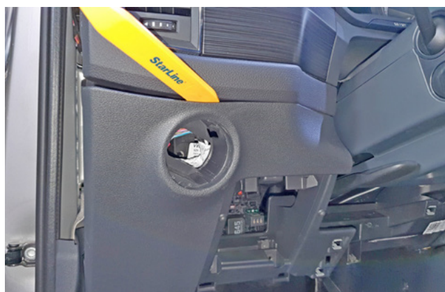
Фото 1.11. Снять левую часть накладки под рулевой колонкой
