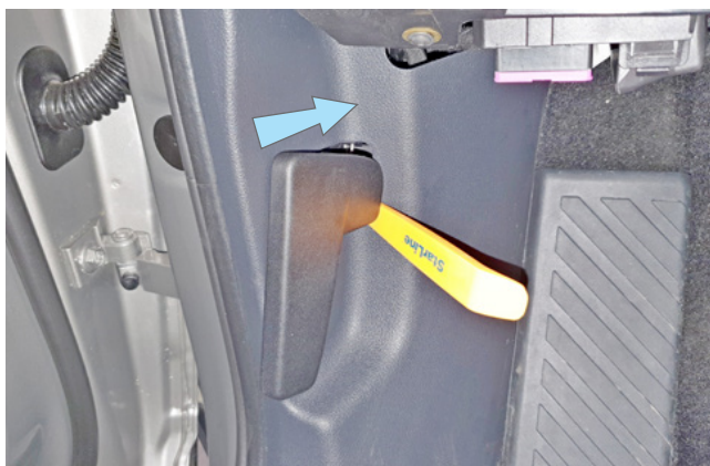
Фото 1.13. Сдвинуть фиксатор ручки отпирания капота в направлении стрелки
