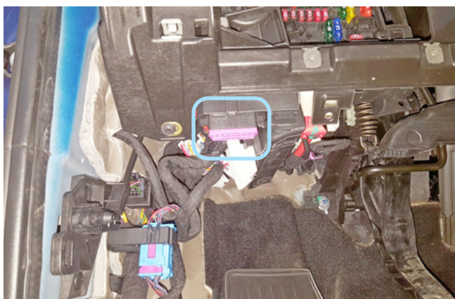
Фото 3.5. Местоположение диагностического разъёма
