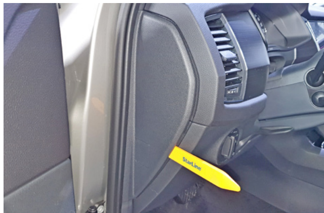
Фото 1.2. Снять левую боковую накладку передней панели
