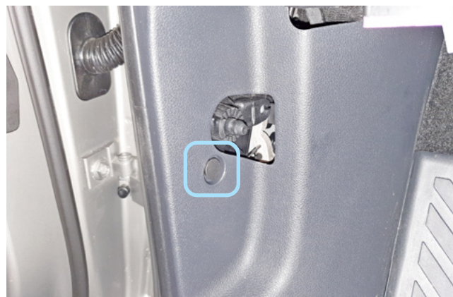
Фото 1.14. Ручка отпирания капота снята. Клипса крепления накладки левой кик-панели
