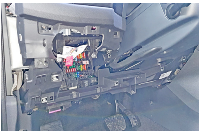
Фото 1.12. Пластиковая накладка под рулевой колонкой снята
