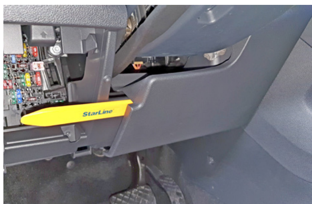
Фото 1.10. Снять правую часть накладки под рулевой колонкой
