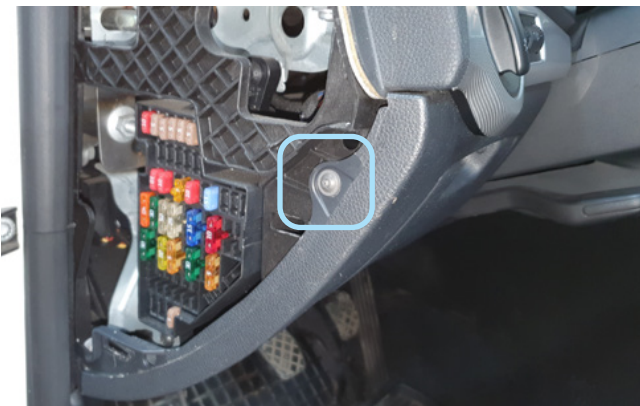
Фото 1.3. Боковая накладка снята. Саморез
