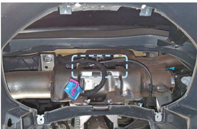
Фото 2.7. Пример расположения центрального блока охранно-телематического комплекса
