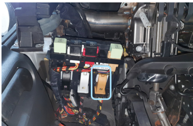
Фото 3.2. Местоположение разъёма на блоке BCM
