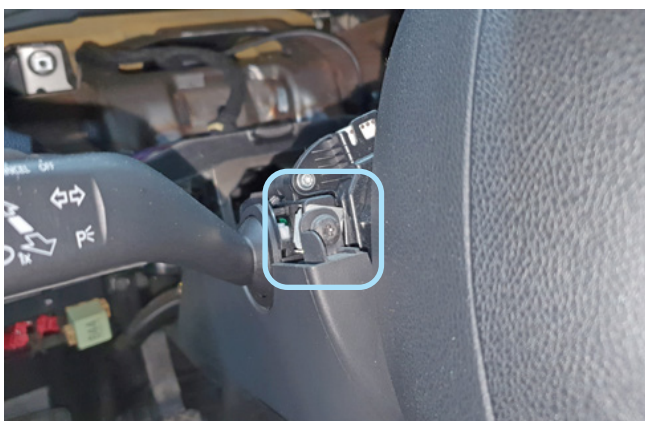
Фото 1.17. Винт крепления нижней части кожуха слева
