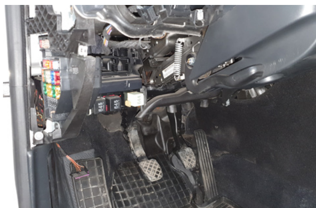
Фото 1.10. Пластиковая накладка под рулевой колонкой снята
