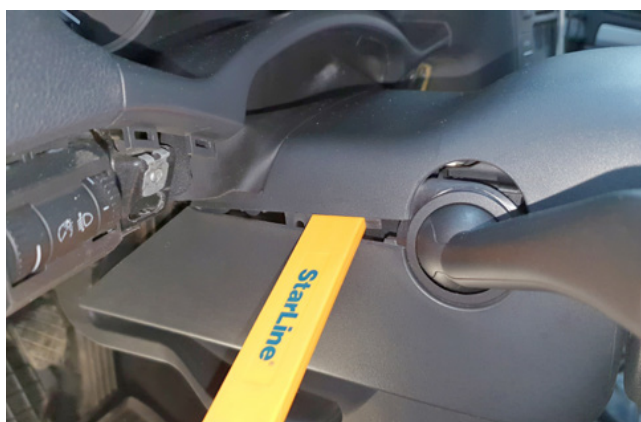
Фото 1.12. Снять верхнюю часть кожуха рулевого вала
