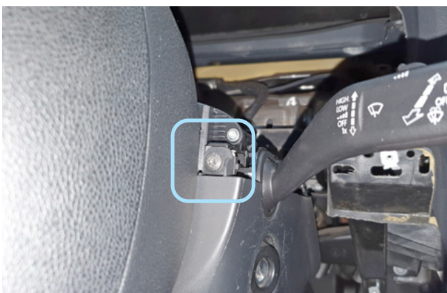
Фото 1.18. Винт крепления нижней части кожуха справа
