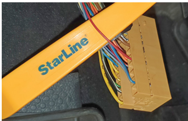
Фото 3.6. Альтернативное управление световыми сигналами (коричнево-красный)
