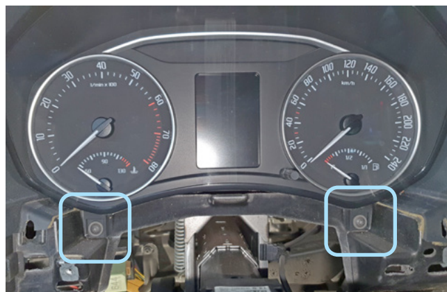
Фото 1.14. Декоративная накладка снята. Саморезы
