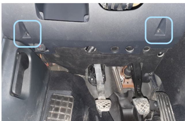
Фото 1.9. Саморезы крепления пластиковой накладки под рулевой колонкой
