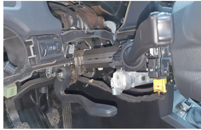
Фото 1.20. Кожух рулевого вала снят
