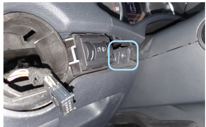
Фото 1.6. Накладка снята. Саморез
