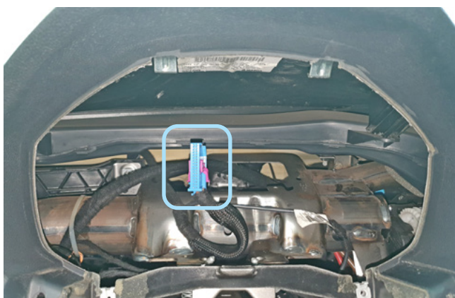
Фото 3.4. Местоположение разъёма панели приборов
