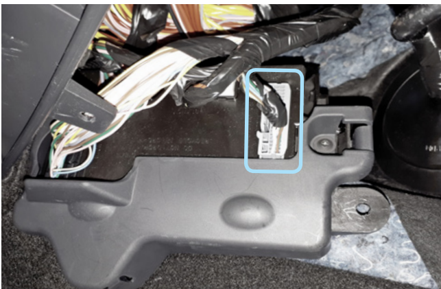
Фото 3.10. Местоположение серого разъёма S2
