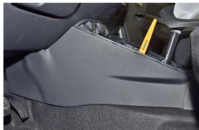
Фото 1.6. Снять боковую накладку центрального тоннеля
