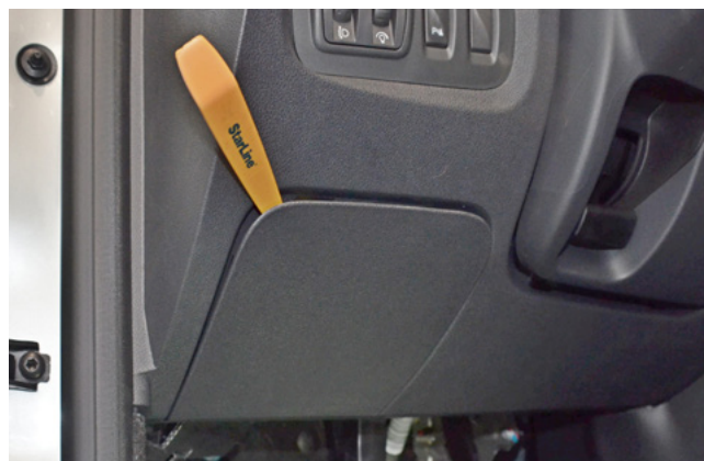
Фото 1.2. Снять крышку монтажного блока предохранителей
