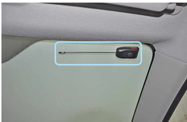
Фото 2.1. Возможное место установки антенного модуля
