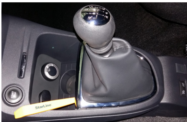
Фото 1.3. Снять декоративную накладку чехла рычага коробки передач
