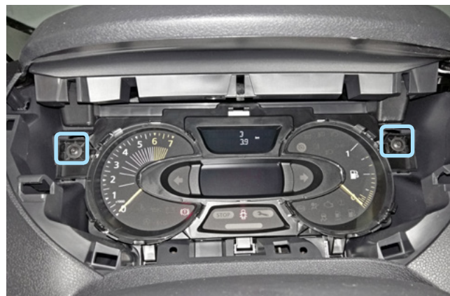
Фото 1.10. Саморезы панели приборов
