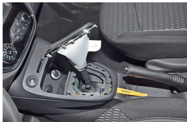
Фото 1.4. Снять верхнюю накладку центрального тоннеля
