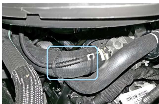
Фото 2.6. Крепление датчика температуры двигателя
