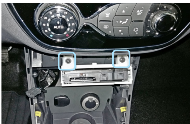
Фото 1.5. Саморезы блока SmartKey
