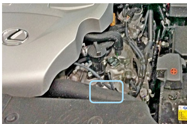
Фото 2.4. Место установки датчика температуры двигателя
