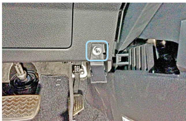
Фото 1.9. Болт крепления накладки под рулевой колонкой справа
