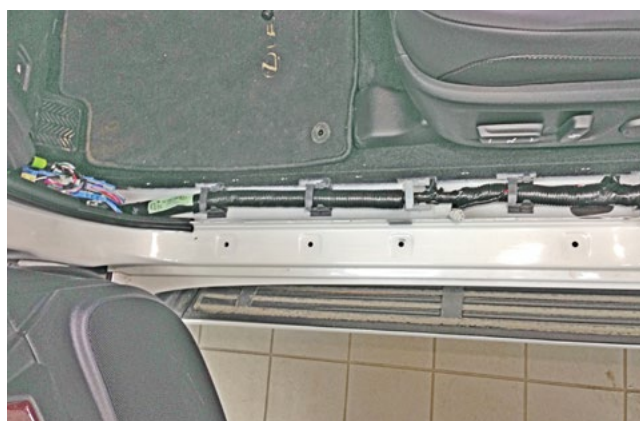
Фото 1.4. Накладки порога и кик-панели сняты
