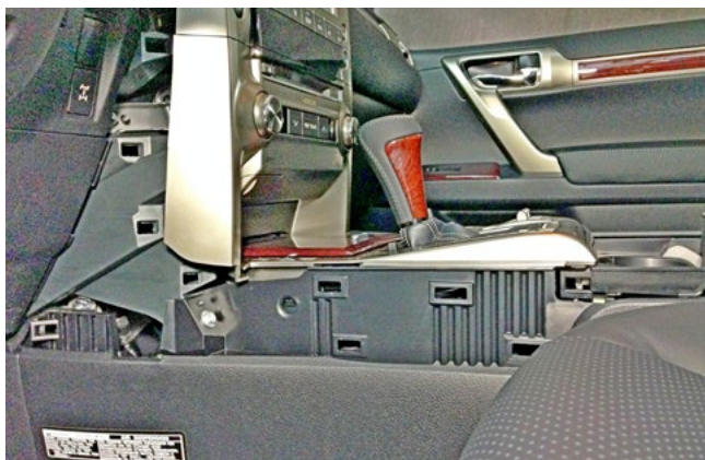
Фото 1.7. Левая накладка центральной консоли снята
