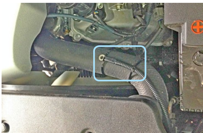
Фото 2.5. Крепление датчика температуры двигателя
