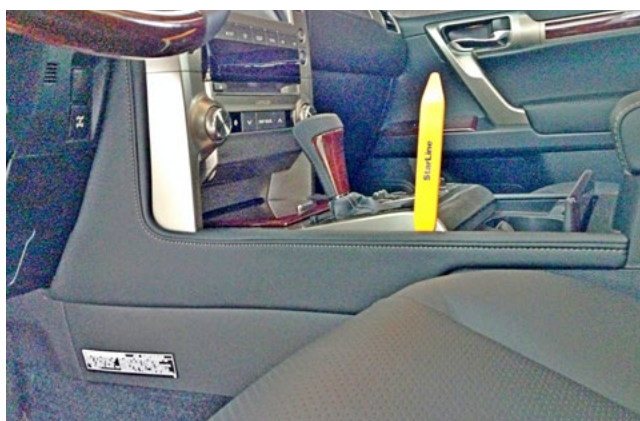
Фото 1.6. Снять левую накладку центральной консоли
