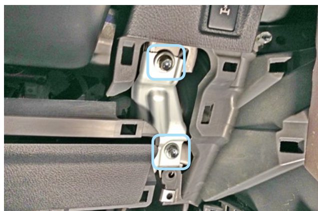
Фото 1.16. Болты крепления подушки безопасности справа
