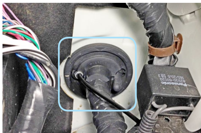
Фото 2.6. Штатный уплотнитель. Вид со стороны капота
