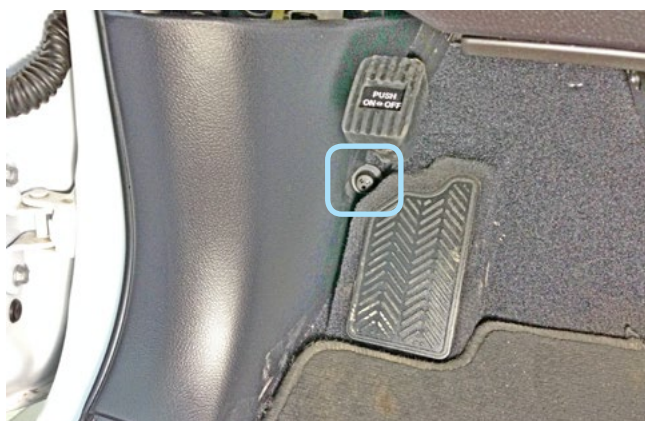
Фото 1.3. Клипса крепления накладки левой кик-панели
