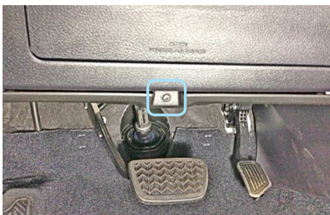
Фото 1.5. Накладка педального узла. Саморез
