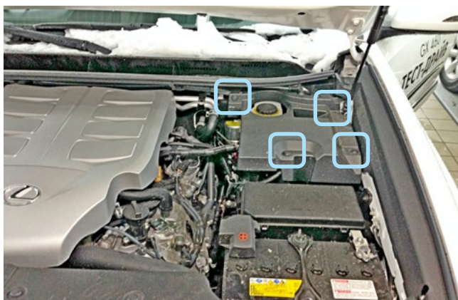
Фото 2.1. Клипсы крепления декоративной накладки моторного отсека
