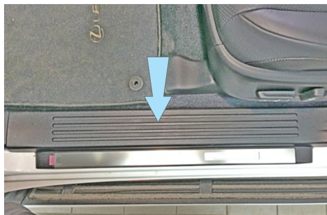
Фото 1.2. Накладка порога двери водителя
