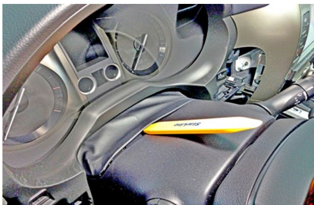
Фото 1.17. Снять декоративную накладку панели приборов и пылезащитный кожух рулевой колонки
