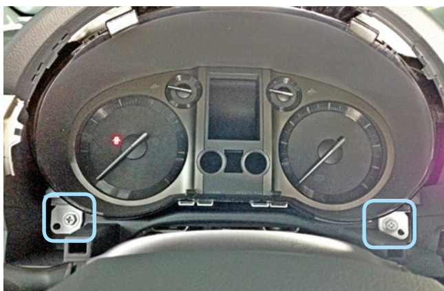
Фото 1.19. Саморезы крепления панели приборов
