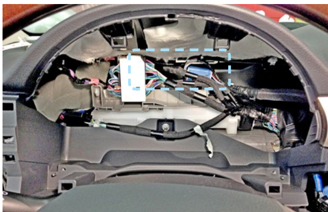
Фото 2.8. Пример расположения центрального блока охранно-телематического комплекса
