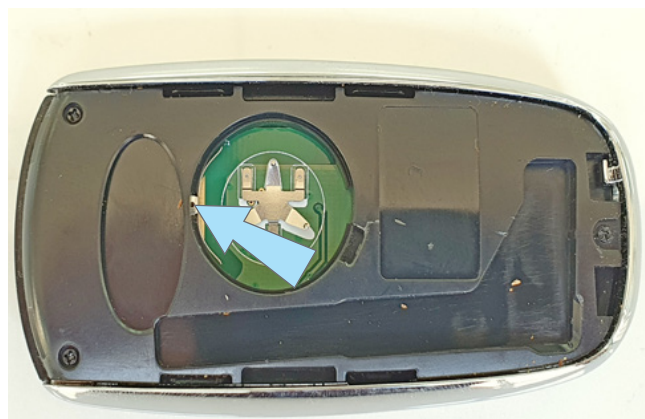
Фото 3.16. Контактная площадка (+) на плате ключа
