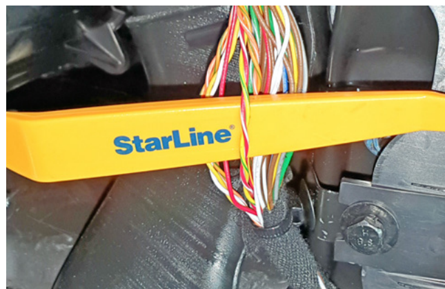
Фото 3.14. Провода антенны штатного иммобилайзера (красно-белый и жёлто-зелёный)
