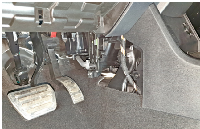
Фото 1.8. Накладка центрального тоннеля снята
