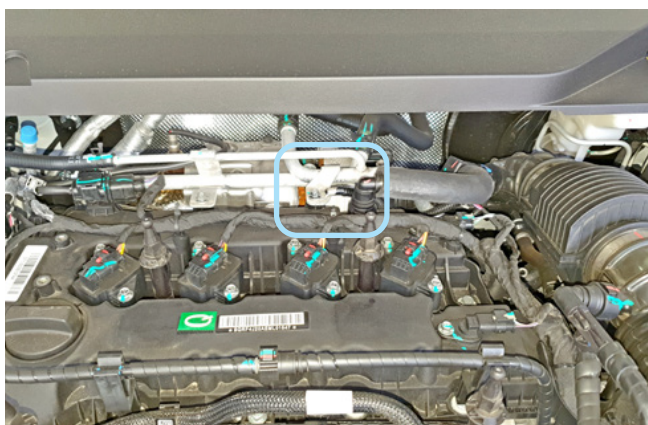
Фото 2.4. Место установки датчика температуры двигателя
