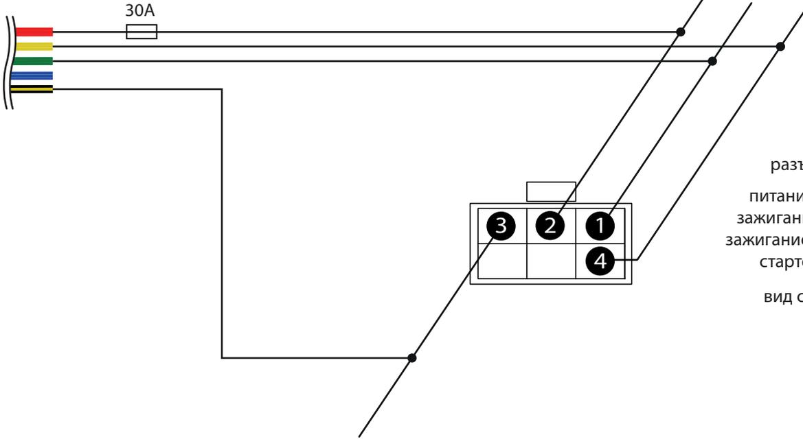
разъём замка зажигания
