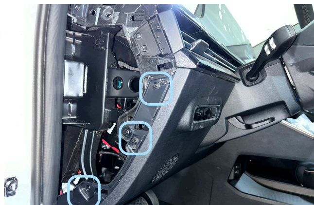
Фото 1.3. Боковая накладка снята, саморезы крепления накладке подрулевой колонкой
