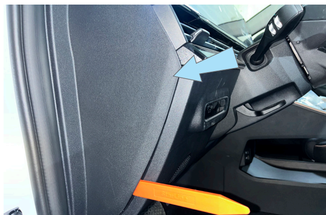
Фото 1.2. Снять боковую накладку
