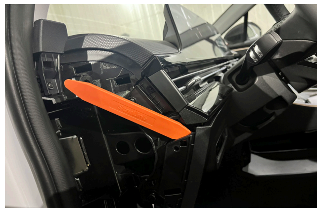
Фото 1.4. Снять накладку подрулевой колонкой
