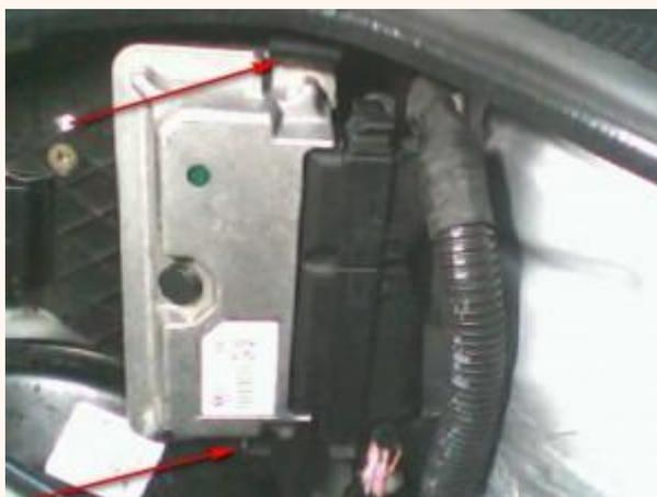
Далее снимаем сам пластиковый кронштейн, открутив два пластмассовых болта:
