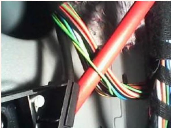
При этом для закрывания подаём на провод «-», а для открывания подаём «-» через резистор **240 Ом**.
