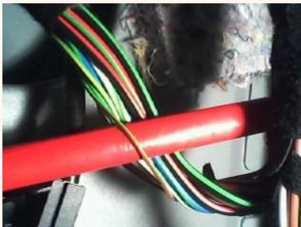
При этом для открывания на провод подаём чистый «-», а для закрывания «-» через резистор **1 кОм**. Такое подключение как бы дублирует кнопку на водительской двери.
